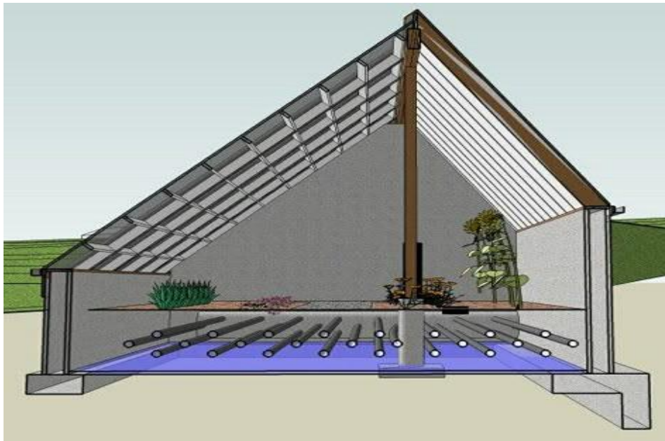
Рис. 1.1 Загальний вигляд промислової земляної зимової теплиці
