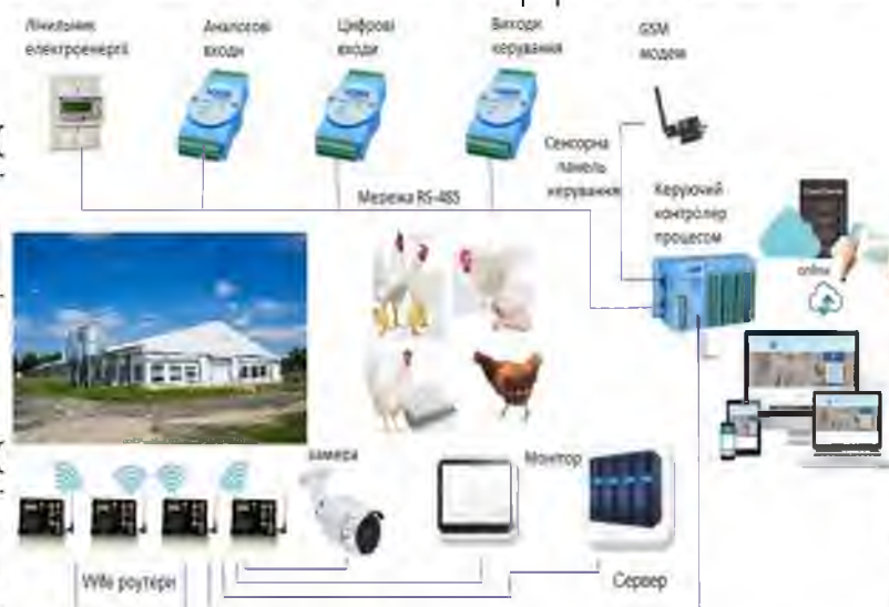
Рис.3.11 Керування птахофабрикою з використанням смайт технології
