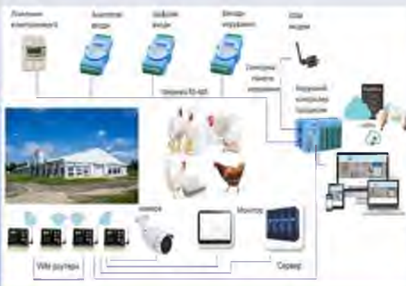
Рис. 3.11 Автоматизований комплекс птахофермою
