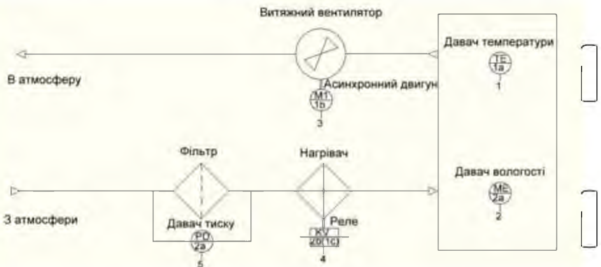
Рис. 3.9 Схема керування автоматизованої електромеханічної системи підтримки мікроклімату
