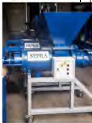
Рис.2.16 Шнековий сепаратор SEBRA
