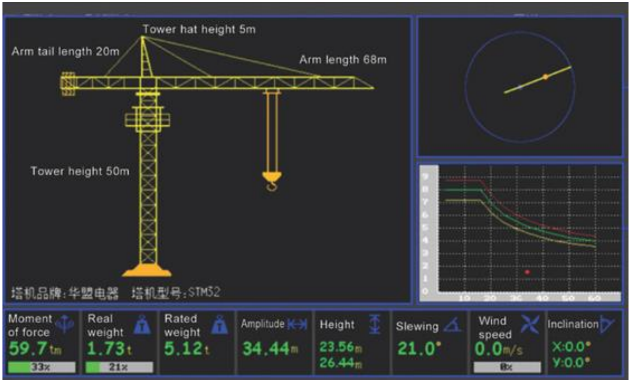
Рисунок 3.2 – Інтерфейс програмного забезпечення до баштового крану з показниками усіх датчиків
