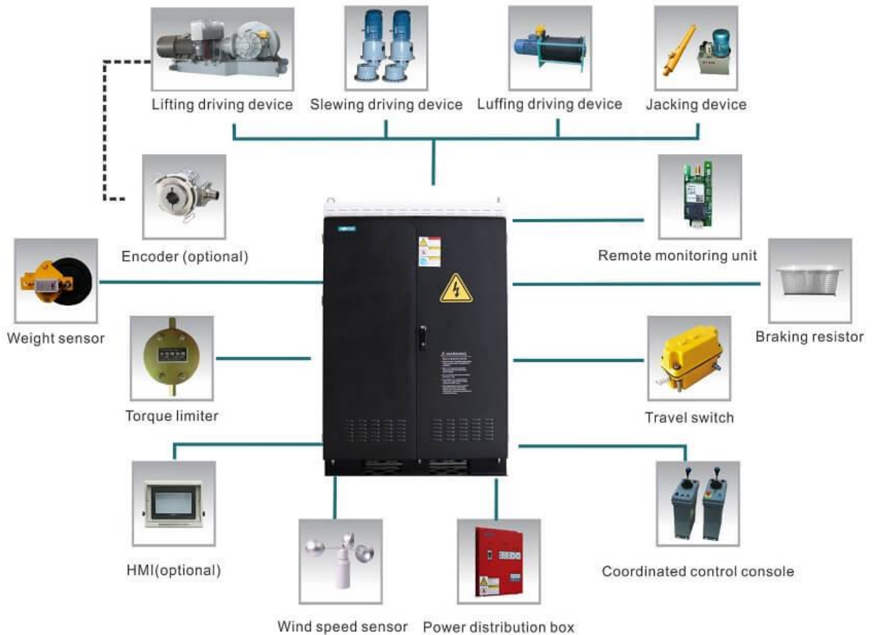
Рисунок 3.1 – Компоненти електричної шафи баштового крана
