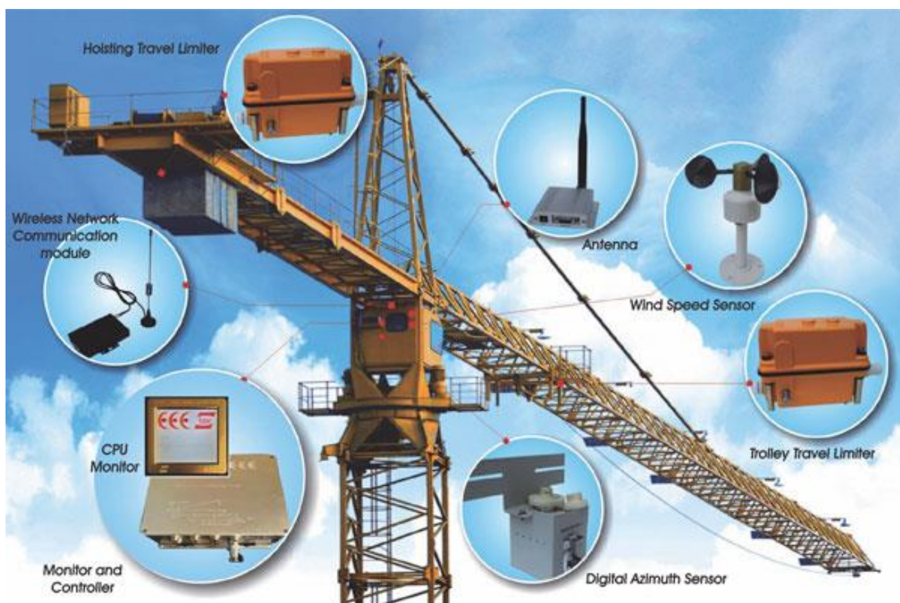
Рисунок 5.3 – Перелік датчиків, які допомагають уникати небезпечних ситуацій при експлуатації баштових кранів
