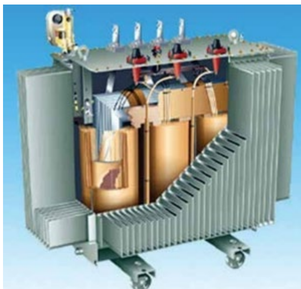
Рис.11.7. Трансформатор без розширювального бака.
