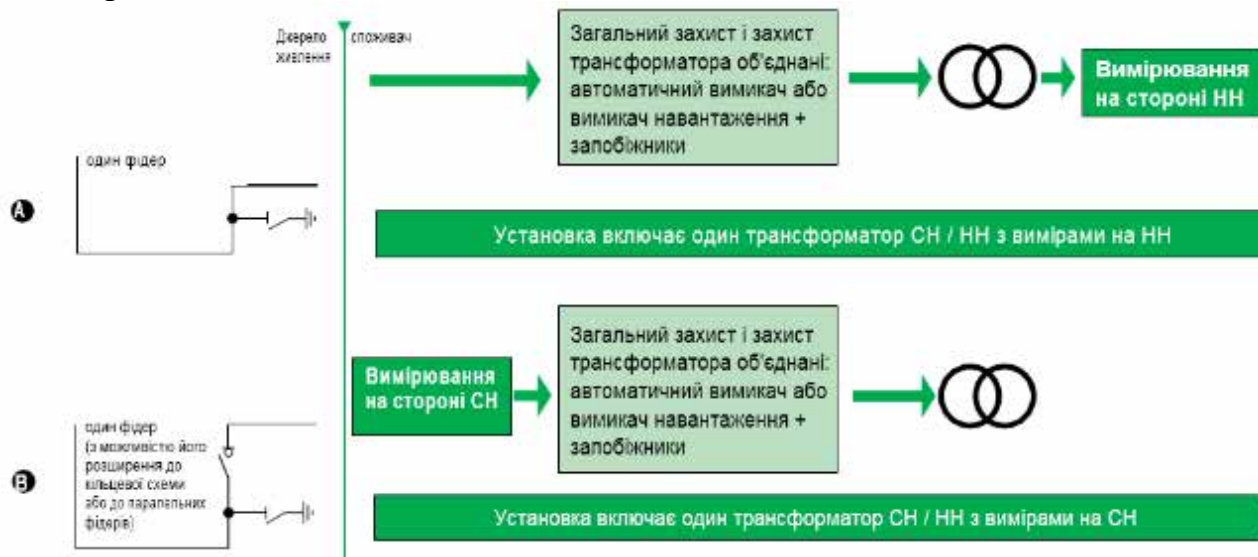
Рис. 2.18. Радіальна схема електропостачання: А - один фідер; В - один фідер з можливістю його розширення до кільцевої схеми або до паралельних фідерів.
