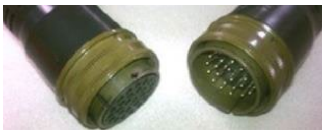
Рис. 12.19. Кабель з алюмінієвим кабельним з'єднувальним кільцем.
