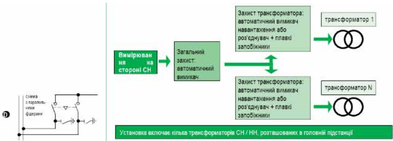
Рис. 2.18. D - подвійна магістраль електропостачання. Схема з паралельними фідерами.
