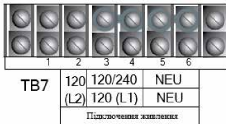
Рис. 12.25. Заводське підключення за замовчуванням для опції внутрішнього датчика напруги.
