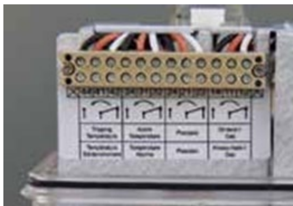
Рис. 11.8 а. Контакти реле захисту трансформатора DGPT (зі знятою кришкою).
