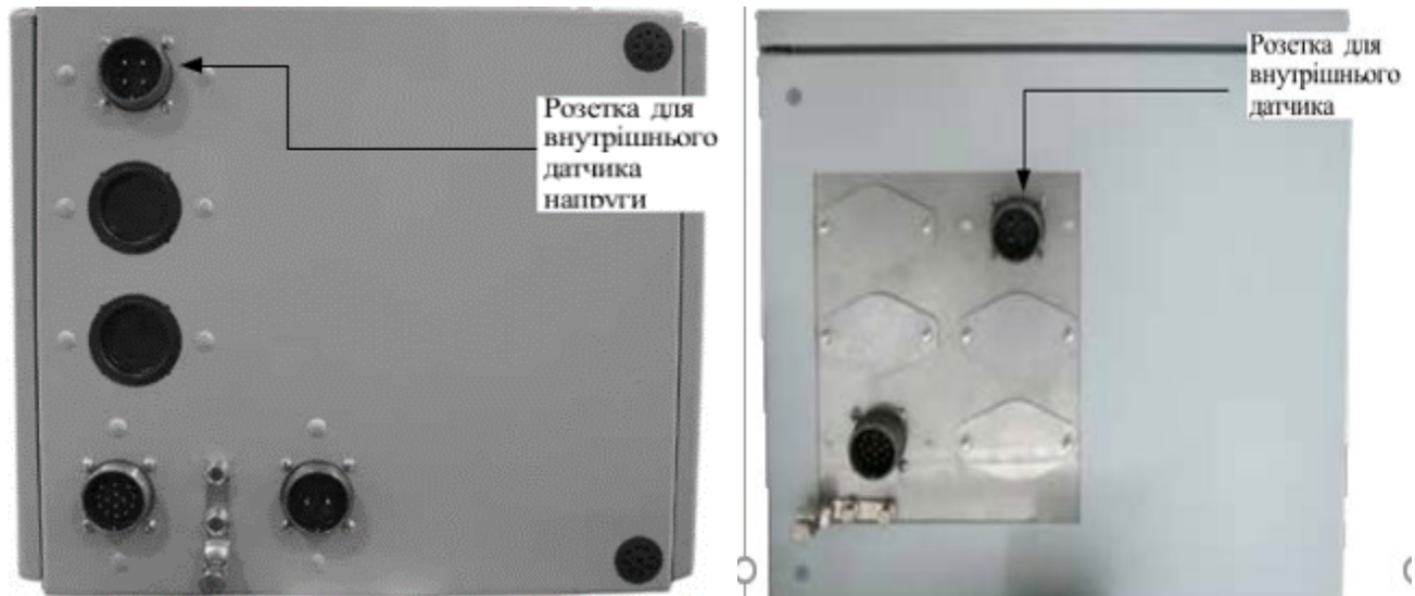
Рис.12.45. Форма 5 гнізда датчика напруги керування.
