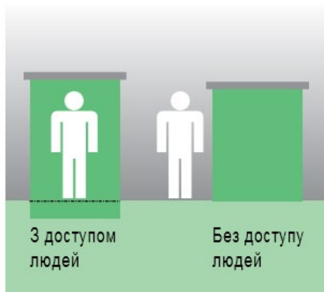
Рис. 2.26. Підстанції з доступом і без доступу людей.
