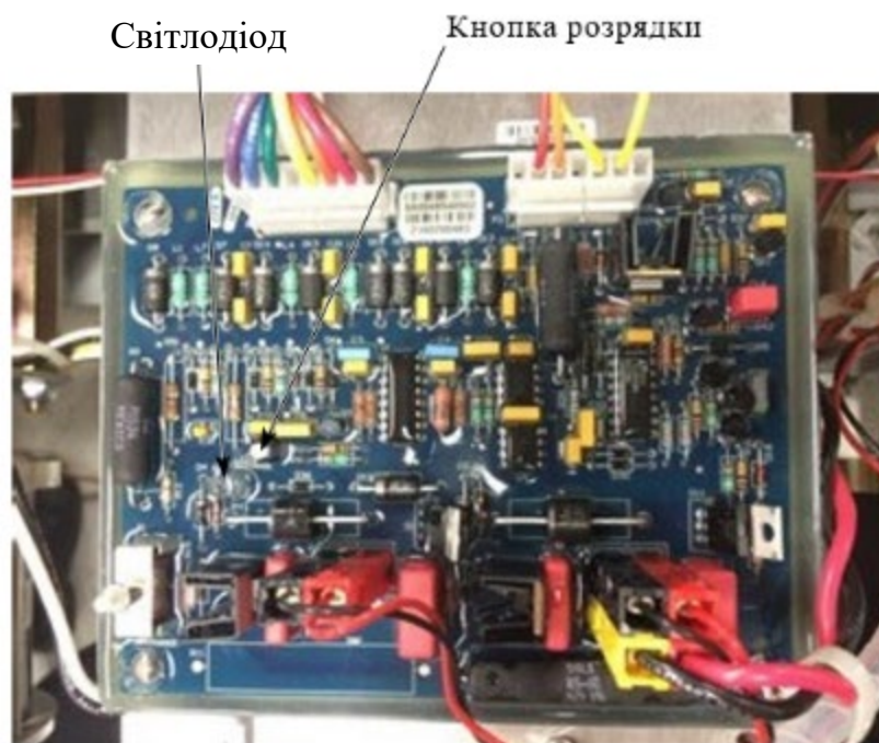
Рис. 12.29. Розташування білої кнопки розряду та світлодіодного індикатора розряду на друкованій платі приводу.
