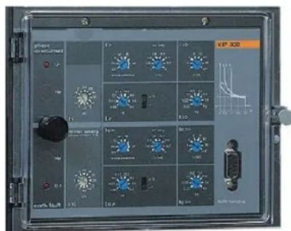
Рис. 11.14. Реле VIP 300 з живленням від контрольованої мережі (зворотнозалежною характеристикою витримки часу), що захищає від перевантаження по струму і від замикань на землю (Schneider Electric).
