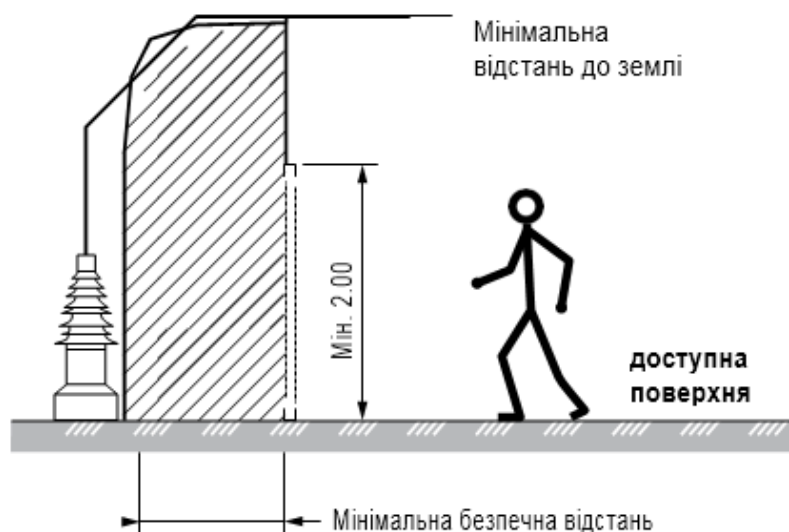
Рис. 11.5 Захист шляхом установки бар'єрів.
