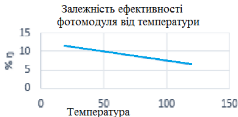
Рис 4.1 Залежність ефективності сонячної панелі від температури
