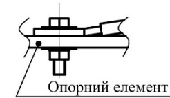
Рисунок 2 Кріплення заземлення ФЕМ
