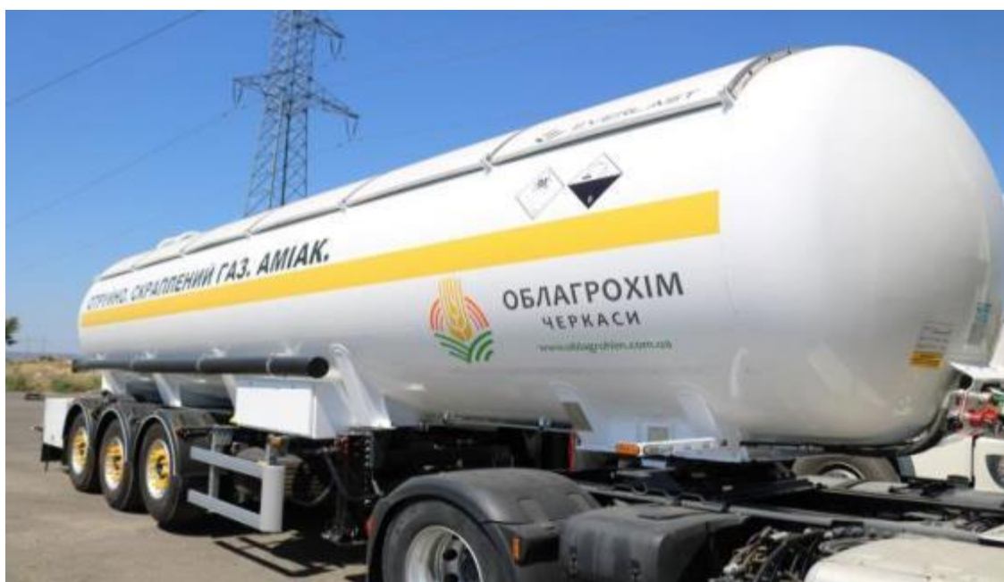
Рис. 2.14. Зовнішній вигляд автоцистерни-аміаковоза
