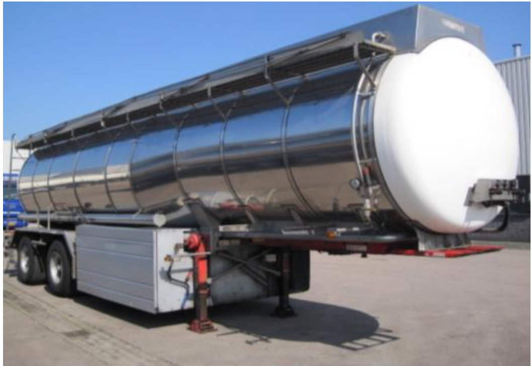
Рис. 2.7. Автоцистерна для транспортування світлих нафтопродуктів ПММ (круглого типу)
