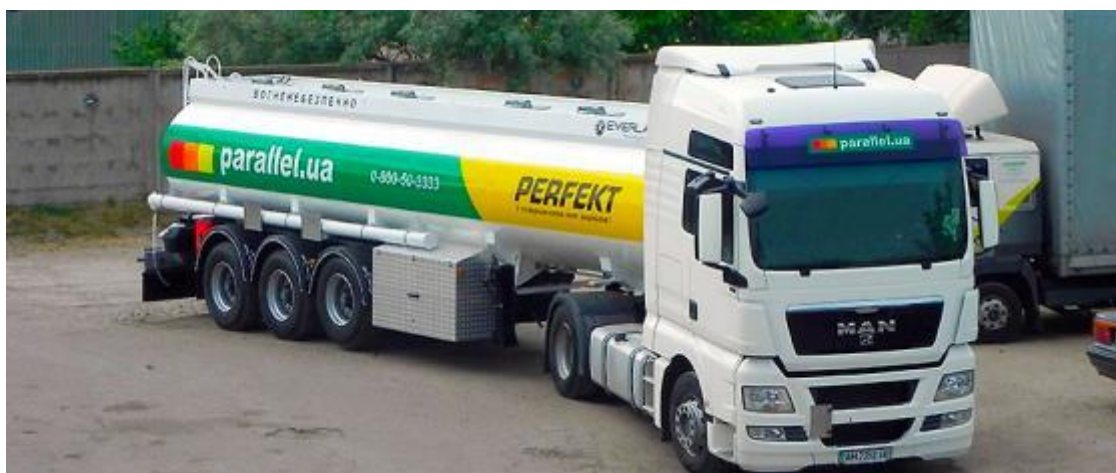
Рис. 2.8. Зовнішній вигляд автоцистерни для світлих нафтопродуктів ПММ ST-EVL (овальної форми)
