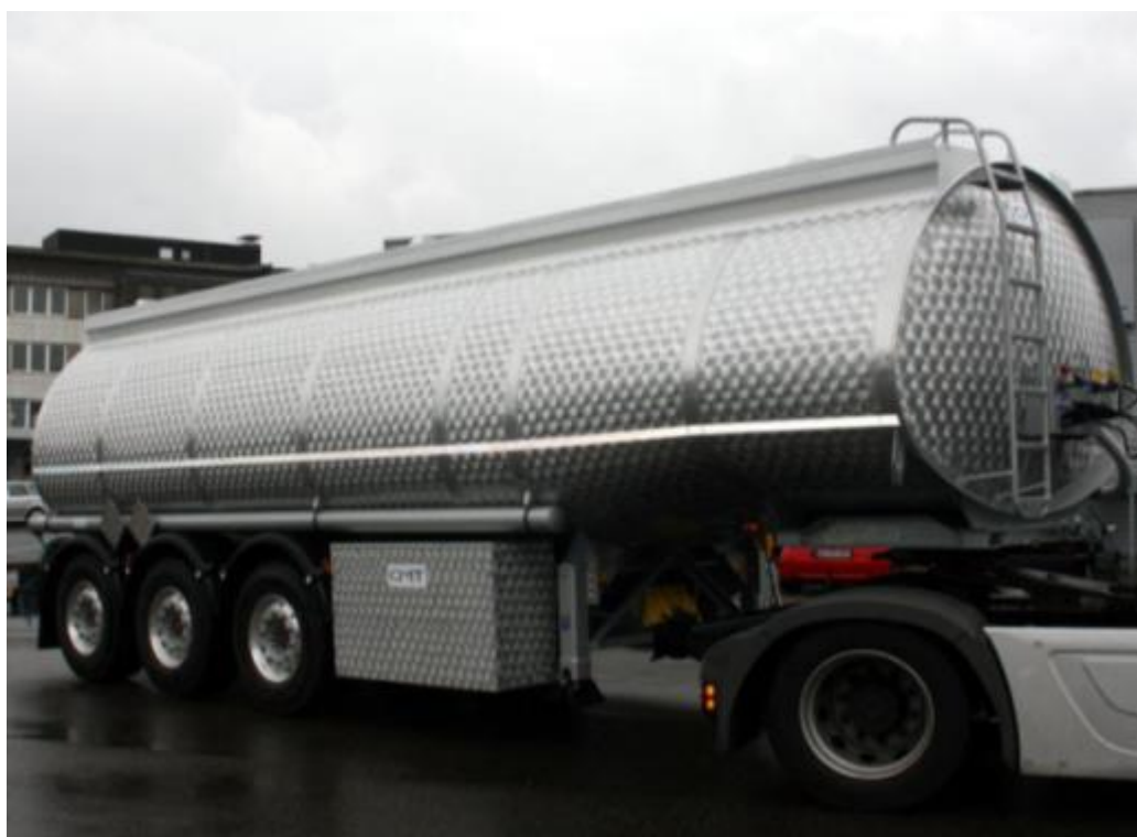
Рис. 2.12. Приклад автоцистерни з нержавіючої сталі
