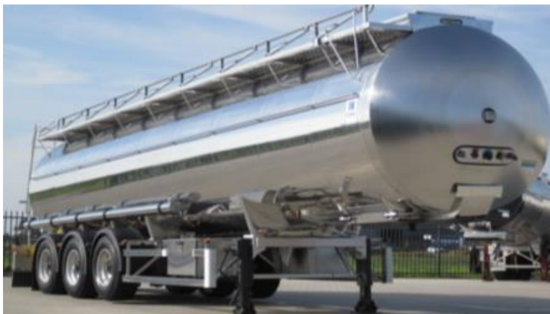
Рис. 2.6. Автоцистерна для транспортування харчових рідин
