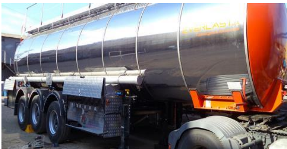
Рис.2.5. Автоцистерна для перевезення хімічних продуктів Ch-EVL
