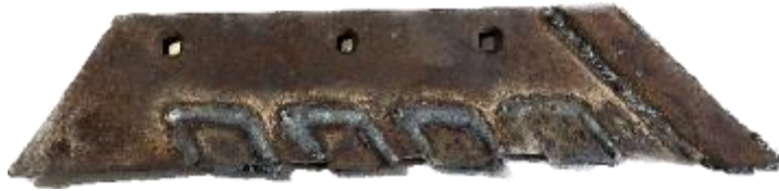
Рисунок 2 – Плужний леміш з постановкою компенсуючих вставок
