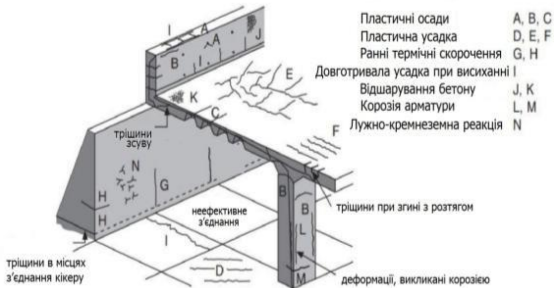
Рис. 1. Класифікація причин появи та утворення тріщин у залізобетонних конструкціях будівель та споруд АПК [2, 4]
