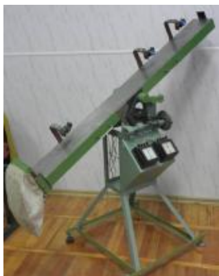
Рис. 5. Загальний вигляд та схема лабораторної установки для визначення коефіцієнта тертя методом скатної площини (за В.О. Желіговським).
