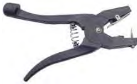
Рис. 82. Щипці для закріплення міток
