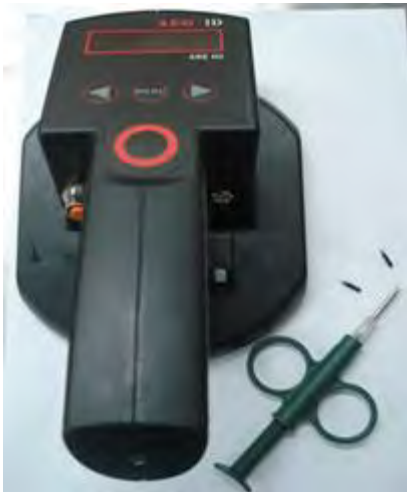
Рис. 88. Засоби при мічені риб за допомогою мікрочипів
