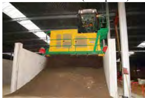
з – Тунельний змішувач-аератор фірми AVONO (Туреччина)
