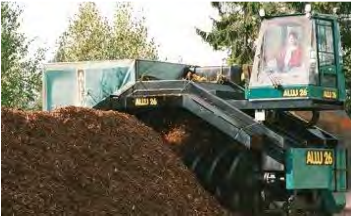
Рис. 1.19 – Розпушувач буртів ALLU, фірми Ideachip (Фінляндія)
