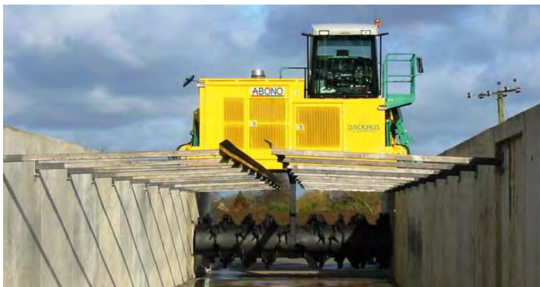
Рис. 1.20 – Змішувач-аератор серії "LT" фірми ABONO (Туреччина)
