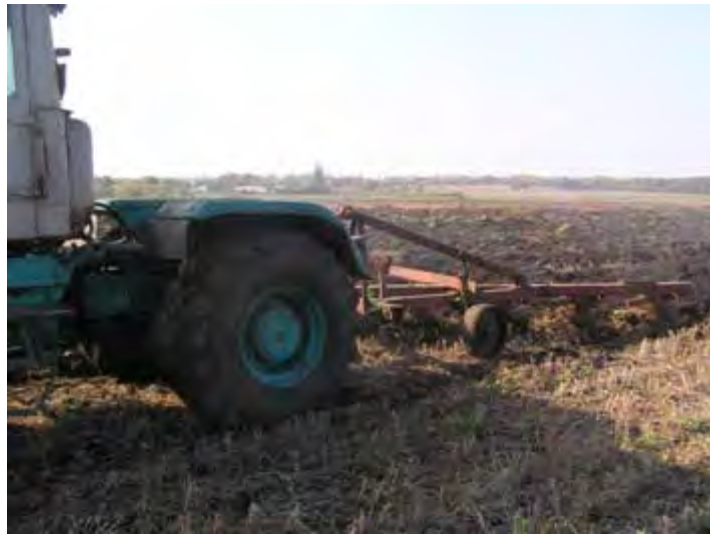
Рис. 2.32 – Вигляд агрегату Т-150К + ПЛН-5-35 в роботі (один з аналогів)
