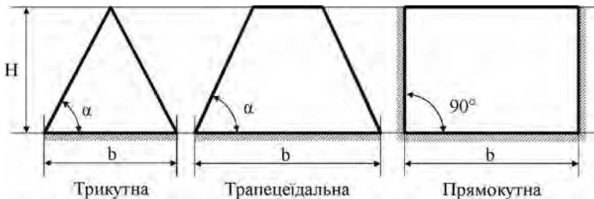
Рис. 1.35 – Форми бурта компостної суміші
