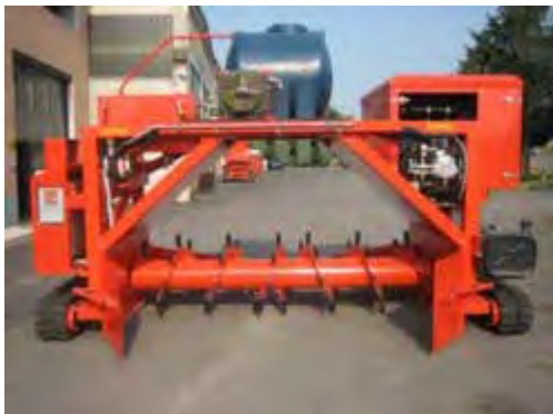
д – Самохідний змішувач-аератор фірми CARAVAGGI SRL (Італія)
