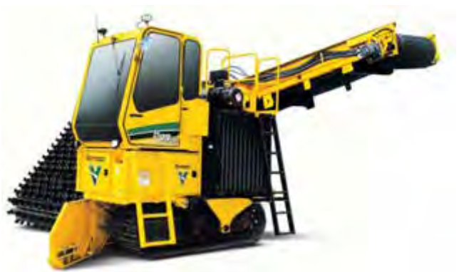
Рис. 1.18 – Змішувачі-аератори навантажувачі з боковим формуванням бурта
