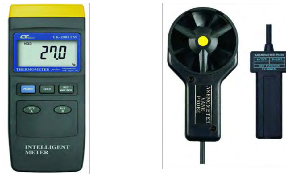
Рис. 3.23 – Анемометр УК-2001 ТМ
