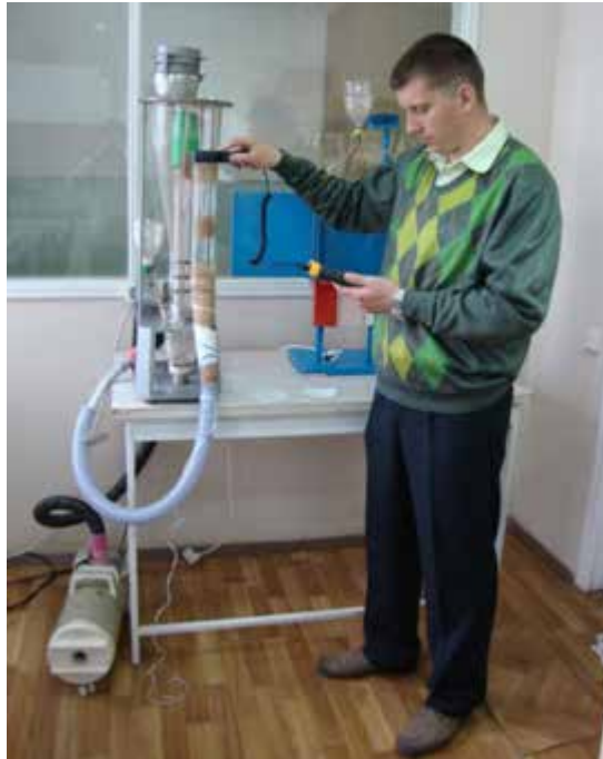
Рис. 3.20 – Вимірювання швидкості зависання фракцій яєць
