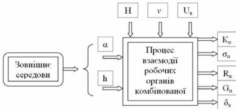
Рис. 2.16 – Структурна схема процесу взаємодії робочих органів комбінованого плуга з ґрунтом
