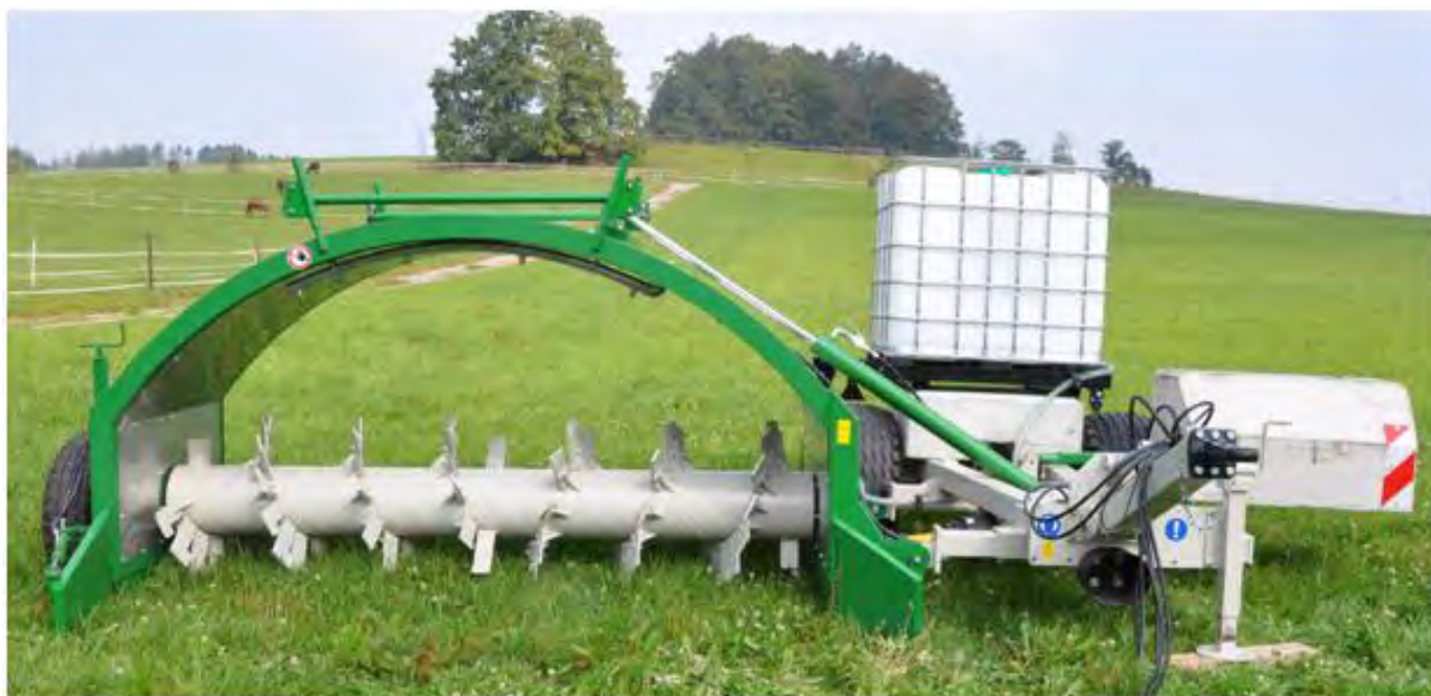
Рис. 1.23 – Роторний аератор-змішувач TG 301 виробництва фірм Gujer
