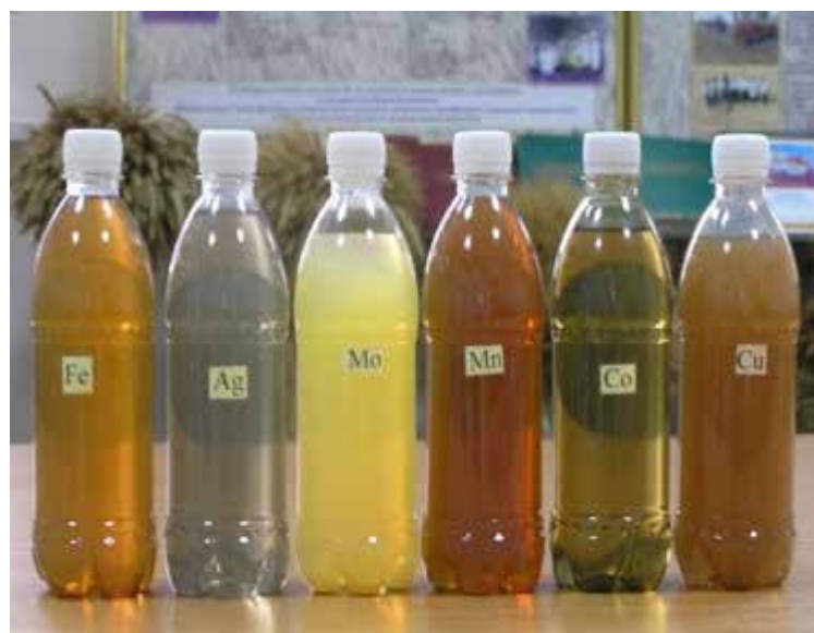
Рис. 4.5 – Колоїди металів, синтезовані електроіскровим диспергуванням металевих гранул у воді
