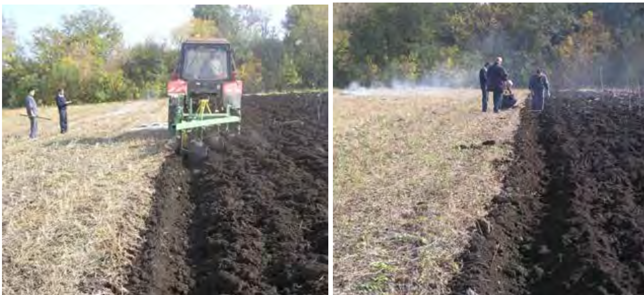
Рис. 2.33 – Визначення показників якості роботи окремих груп робочих органів плуга з дисковим подрібнювачем в агрегаті з трактором МТЗ-82
