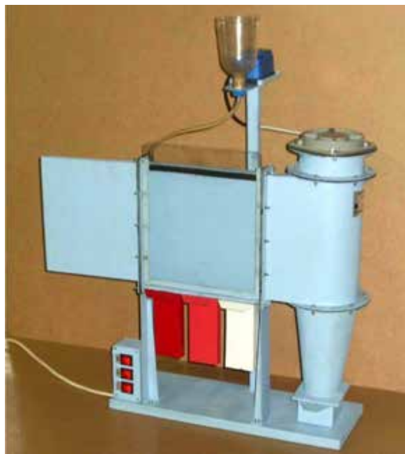
Рис. 3.3 – Калібратор яєць фітофагів
