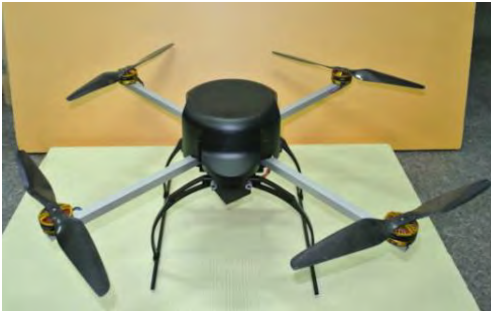
Рисунок 3.70 – Квадрокоптер для внесення трихограми [23]
