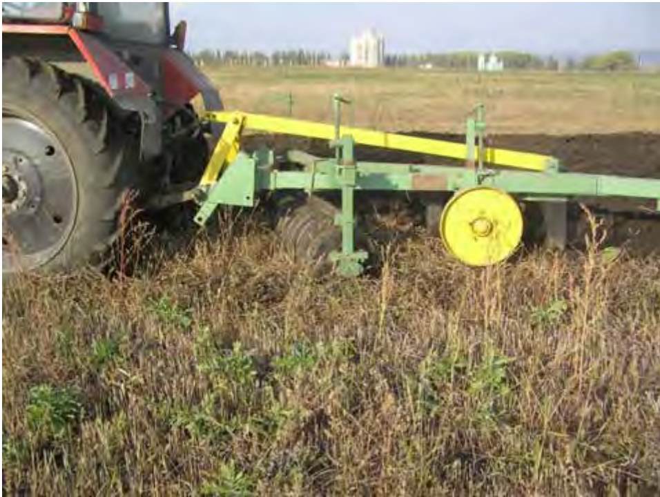
Рис. 2.18 – Плуг з дисковим подрібнювачем в роботі
