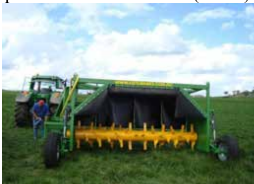
ж – Причіпний змішувач-аератор фірми Sittler (Австралія)
