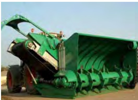
Рис. 1.18 – Змішувачі-аератори навантажувачі з боковим формуванням бурта
