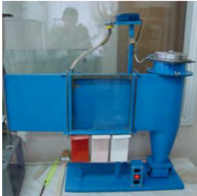
Рис. 3.21 – Загальний вигляд калібратора яєць зернової молі
