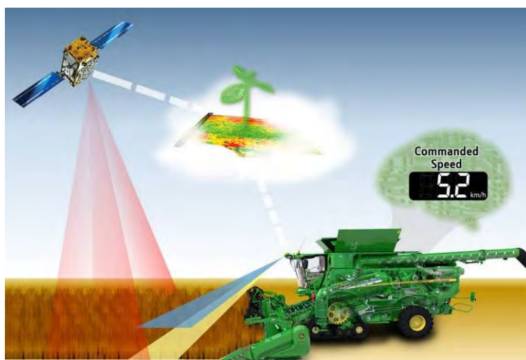
Рис. 1. Схема функціонування системи контролю прогнозованої пропускної здатності Predictive Feedrate Control компанії John Deere
