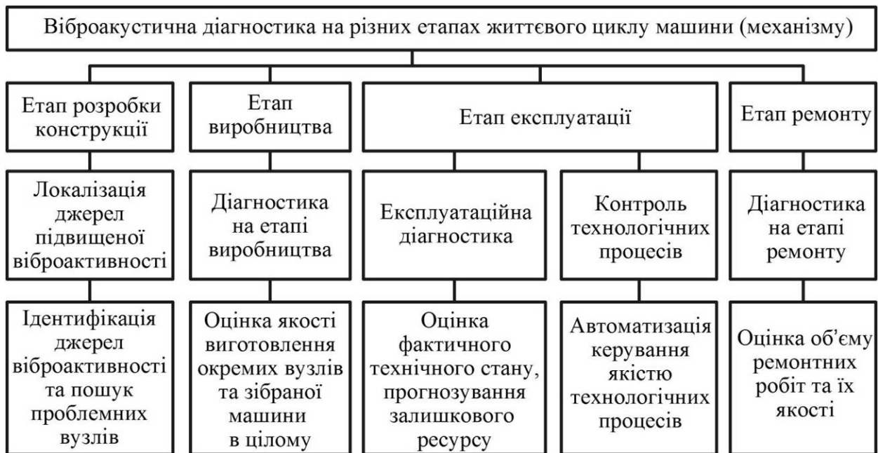
Рис. 2. Застосування віброакустичного контролю на етапах життєвого циклу машин та механізмів
