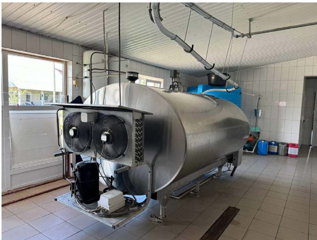
Рис. 2.4. Зберігання молока в резервуарах–охолодниках (фото автора)
