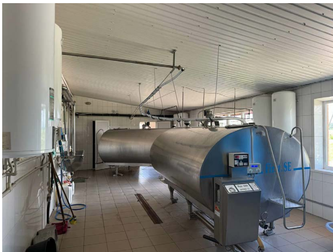
Рис. 2.5. Зберігання молока в резервуарах–охолодниках (фото автора)
