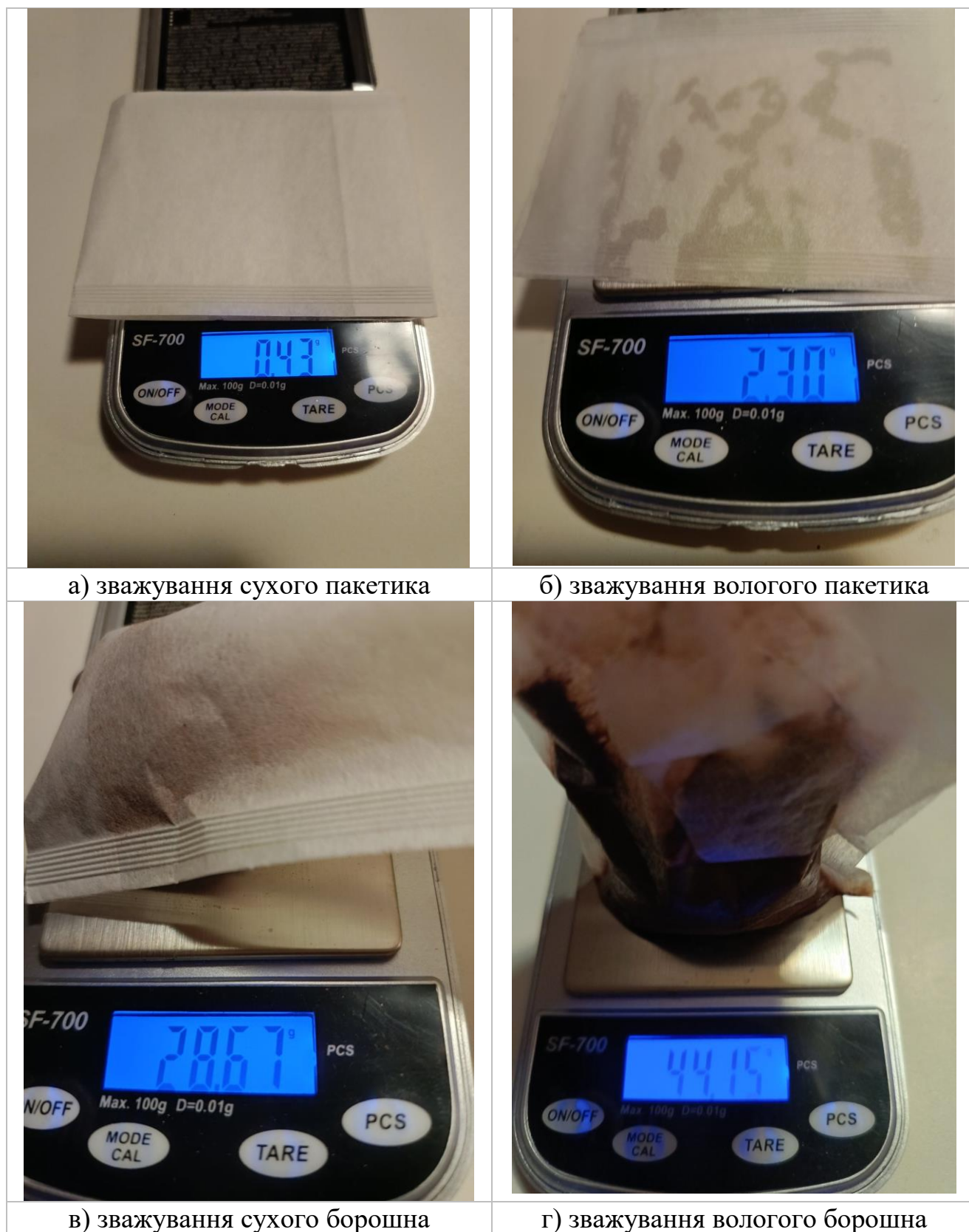
Рис 2.4. Послідовність процесів визначення вологовмісту борошна з туфу.
