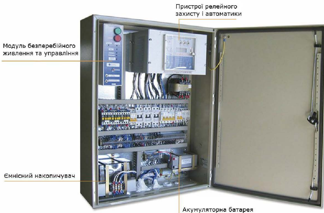
Рис. 4.1. Конструкція низьковольтного модуля реклоузера
