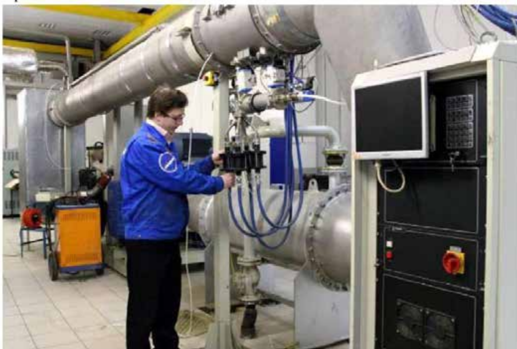
Рисунок 2.4 – Вимірювальна апаратура з тунелем для вимірювання твердих частинок, шкідливих речовин, парникових газів та витрати палива під час випробувань за Правилами ООН №49
