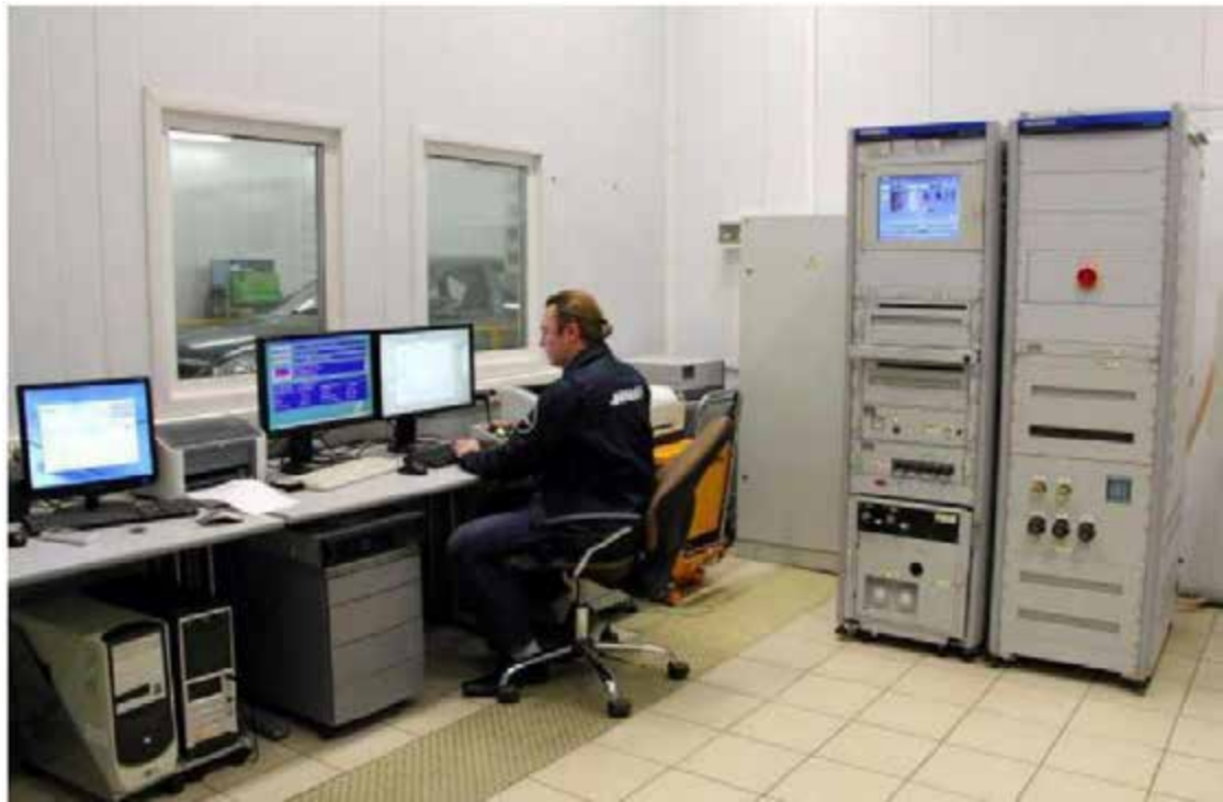
Рисунок 2.2 – Вимірювальна апаратура для вимірювання викидів шкідливих речовин, парникових газів та витрати палива при випробуваннях автомобілів за Правилами ООН №83
