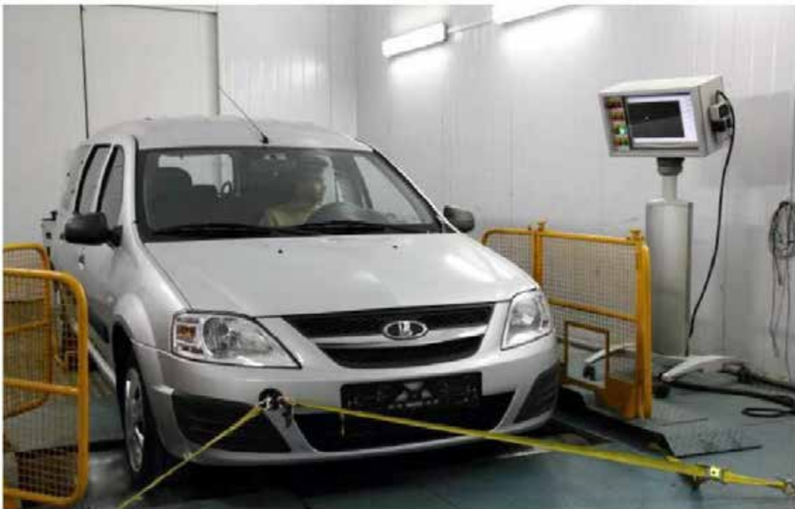
Рисунок 2.1 – Стенд для випробувань автомобілів щодо визначення викидів шкідливих речовин, парникових газів та витрати палива за Правилами ООН №83
