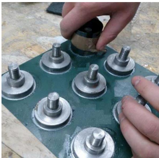
Рис. 3.4. Підготовка пластин до проведення випробувань з визначення адгезійної міцності лакофарбових покриттів
