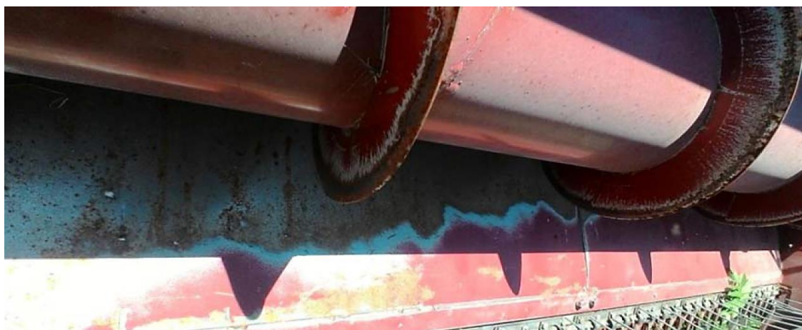
Рис. 2.4. Поверхня днища жатки комбайна Акрос - 530 після двох сезонів роботи
