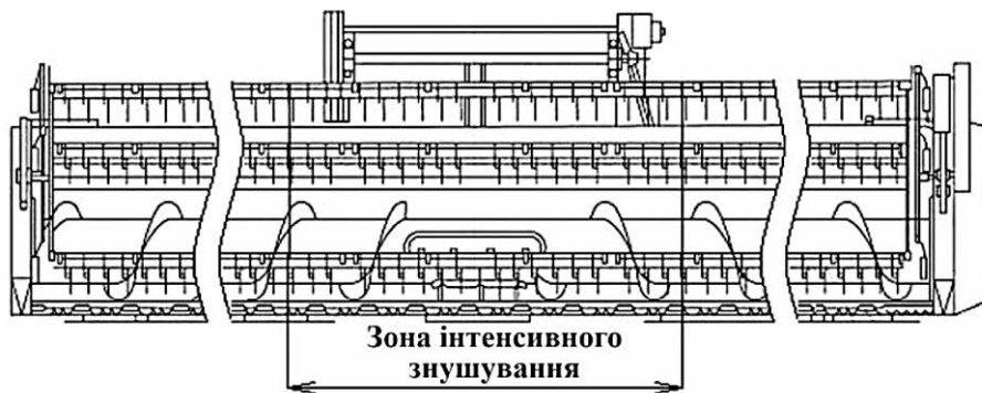
Рис. 4.9. Зона інтенсивного зношування робочих поверхонь жаток зернозбиральних комбайнів
