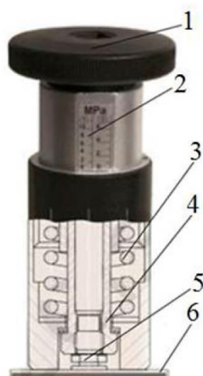
Рис. 3.3. Пристрій для визначення адгезійної міцності лакофарбового покриття
