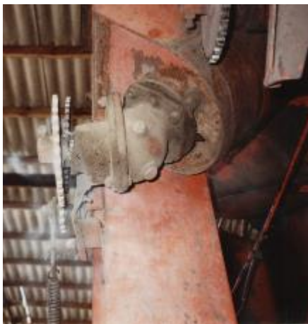
Рисунок 3.4 - Типовий приклад конструктивної відмови - кінематична неточність ланцюгових передач, яка є причиною прискореного зношення і злітання ланцюгів.
