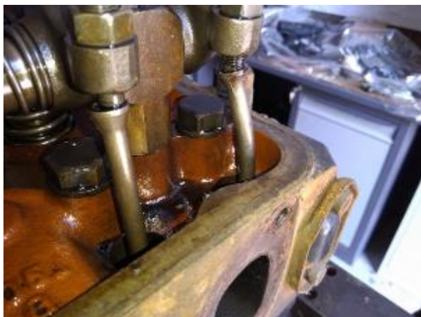
Рисунок 3.9 - Експлуатаційна відмова погнуті штанги двигуна
