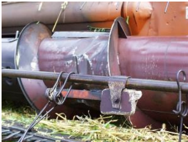
Рисунок 3.7 - Попадання сторонніх предметів під шнек жатки.
