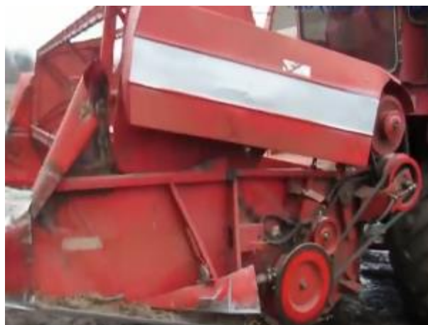
Рисунок 3.7 - Попадання сторонніх предметів під шнек жатки.
