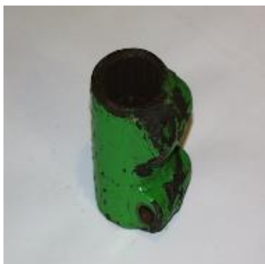
Рисунок 3.6 - Технологічний недолік – а -в шліцьовій муфті відсутній розріз і отвір для стяжного болта. б - обрив фланця запобіжної муфти по зварювальному шву, розсипався підшипник валу соломотрясу.
