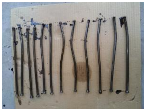
Рисунок 3.9 - Експлуатаційна відмова погнуті штанги двигуна
