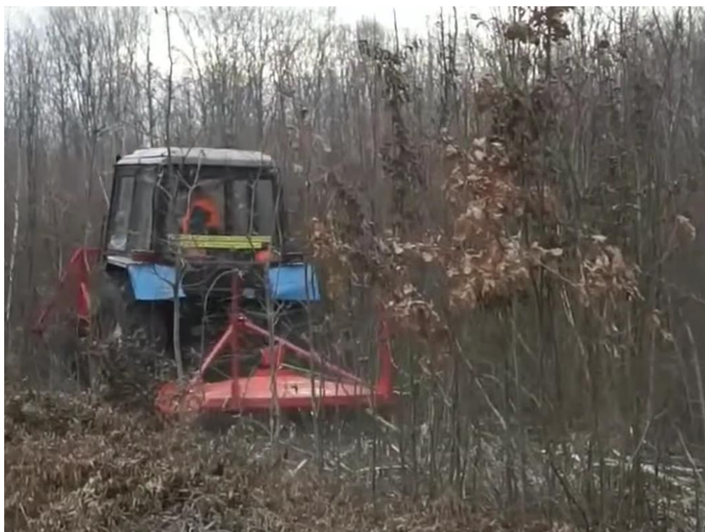
Рис. 4.4. Агрегат Kansas-170, що застосовується для проведення освітлень та почищень у дубових культурах ( фото автора )
