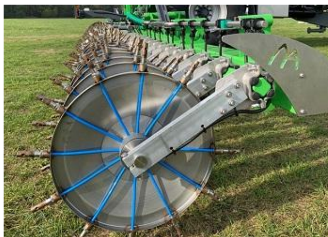
Рис. 3. Система для внутрішньогрунтового внесення рідких мінеральних добрив
