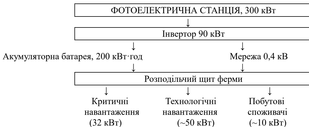
Рис. 2.1. Горизонтальна структурна схема гібридної системи електропостачання ферми ВРХ
