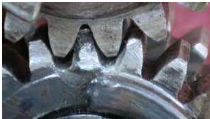
Рис. 1. Руйнування зубів коліс високо-напруженої зубчатої передачі
