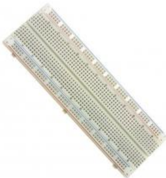
Рисунок 2.11 — Зовнішній вигляд макетної плати (breadboard).
