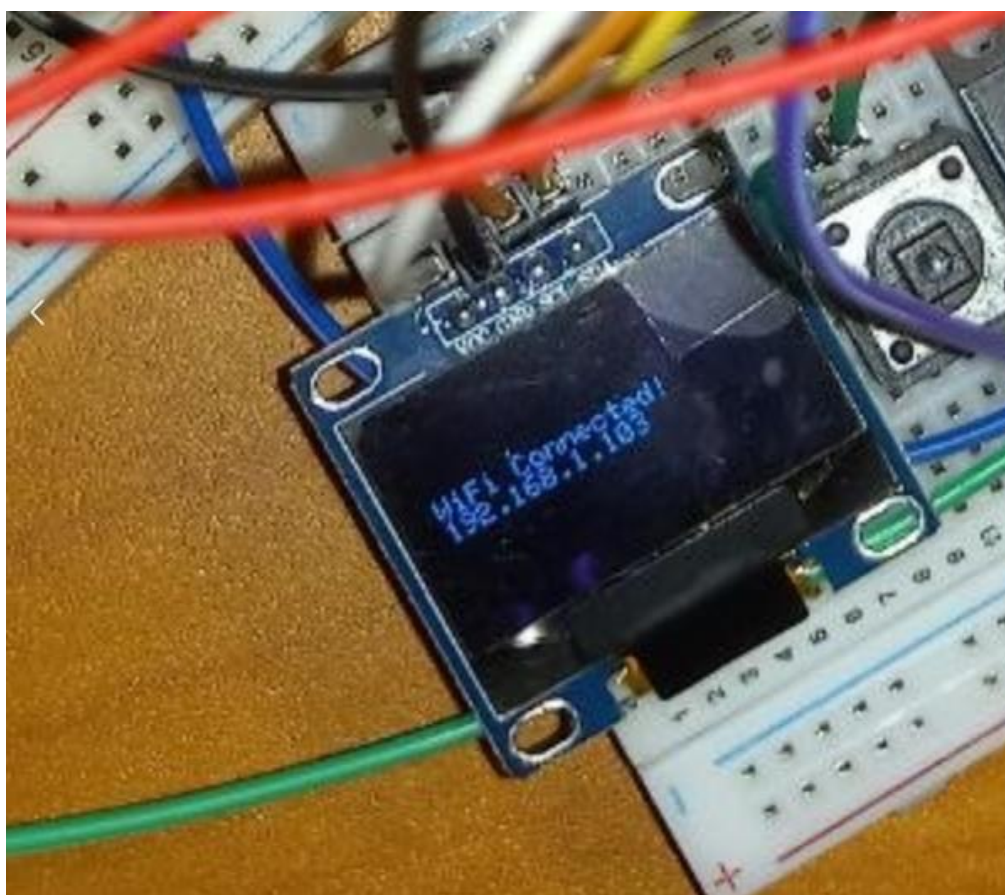
Рисунок 2.15 — Відображення поточної IP-адреси пристрою на OLED-дисплеї
