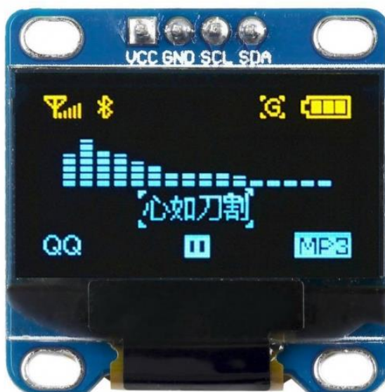
Рисунок 2.8 — Зовнішній вигляд OLED-дисплея 0.96"
