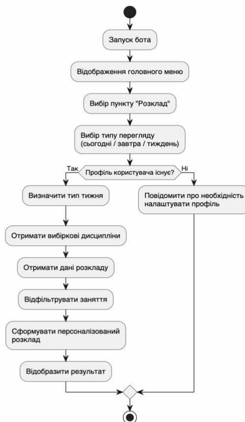
Рис. 3 Діаграма діяльності життєвого циклу взаємодії користувача з Telegram-ботом
