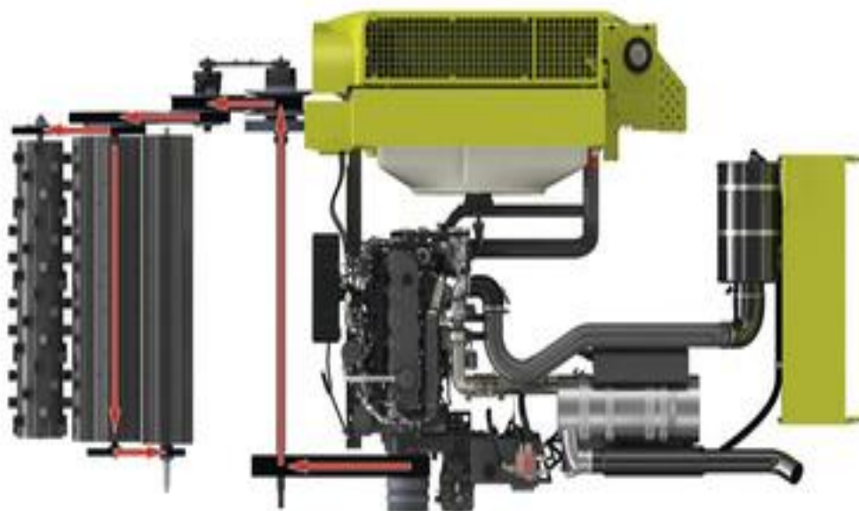
Рисунок 1.4 – Типова конструкція системи очищення зернозбирального комбайна (Claas Lexion):
