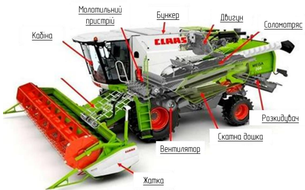
Рис. 1.1 – Загальна схема будови зернозбирального комбайна
