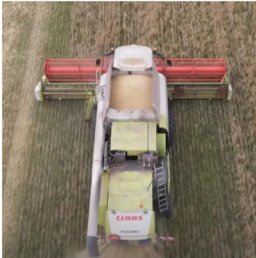
Рисунок 1.3 — Комбайн CLAAS TUCANO 580 з оптимізованою системою очищення зерна [4]
