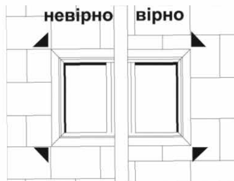
Рис. 16 в. Розташування стиків плит поблизу прорізів.
