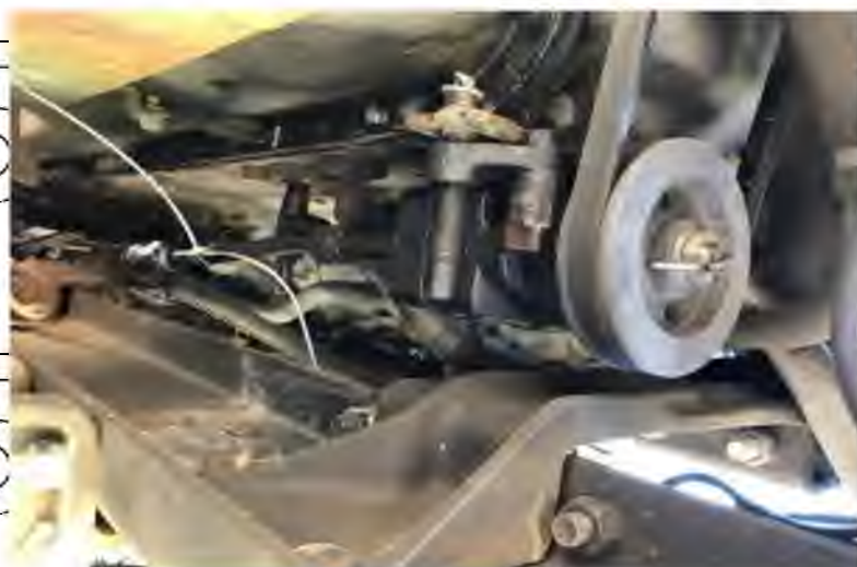
Рис. 3.4 Місце підключення термопар до трубопроводу оливного насосу
