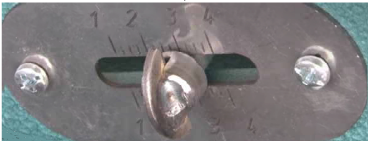
Рис. 4. Загальний вигляд вальців з чистиками (а) та регулювального механізму (б, в) плющилки
