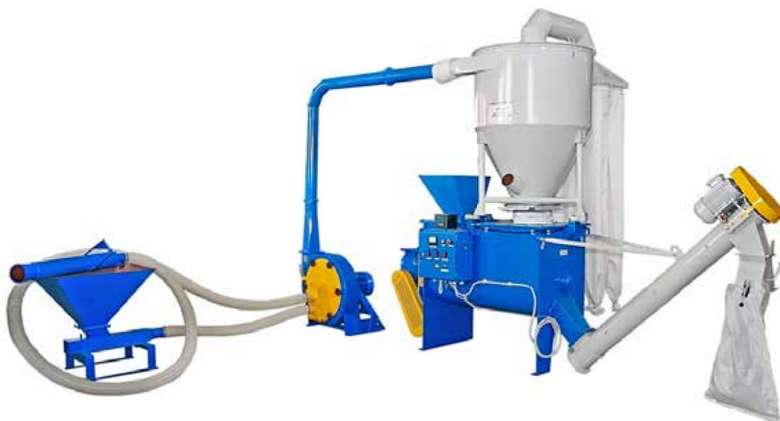
Рис. 7. Загальний вигляд установки з горизонтальним змішувачем стрічково-шнекового типу
