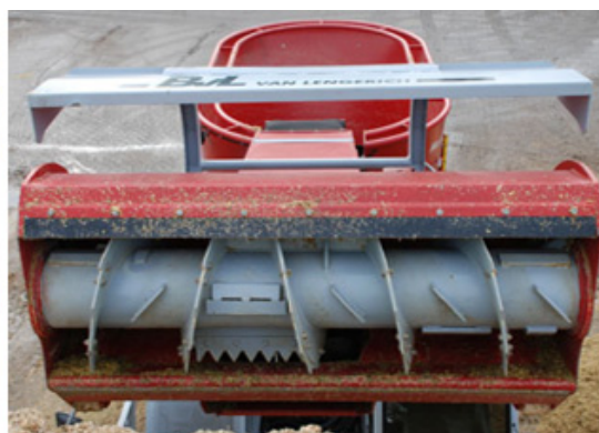
Рис. 11. Вигляд (а) та подрібнююча фреза (б) змішувача-кормороздавача BvL V-MIX
