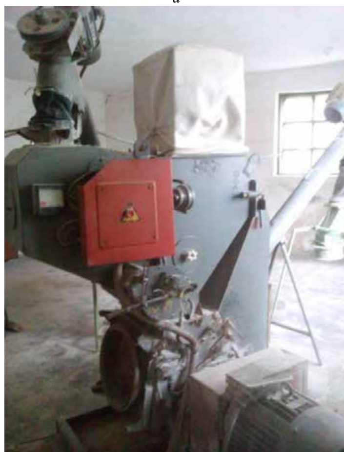
Рис. 2. Конструкційно-функціональна схема (а) та загальний вигляд (б) одноступеневої дробарки (універсальна):
