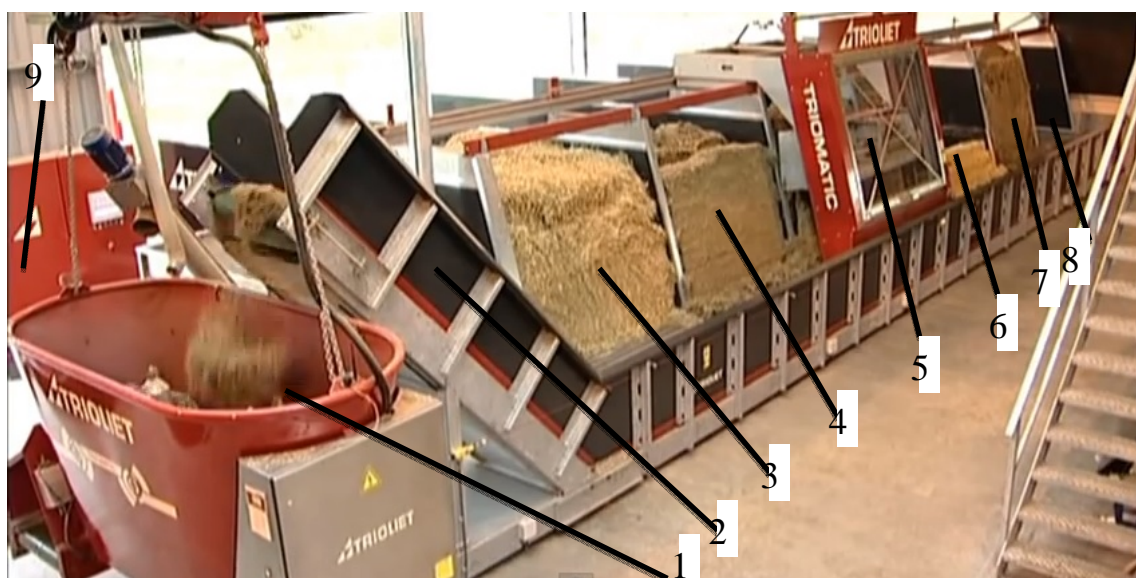
Рис. 3. Схема розміщення технологічного обладнання кормоцеху (для ВРХ):
