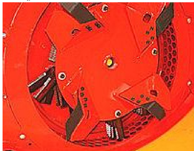
Рис. 9. Загальний вигляд подрібнювача рулонів (а) та його робочого органу(б)
