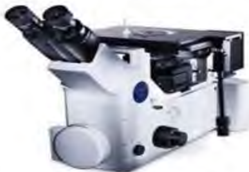
Рис. 3.3 - Інвертований мікроскоп Olympus GX5
