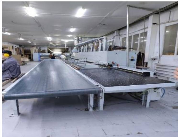
Рис. 2.6. LOORTEQ O-300 механізм повернення деталей до оператора
