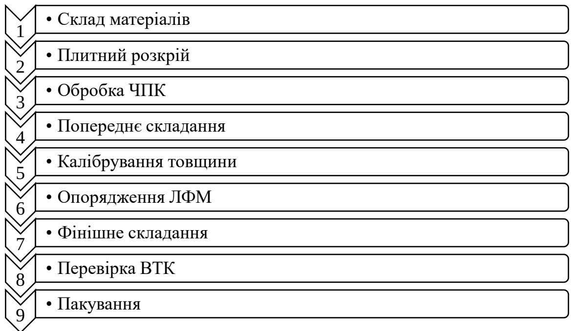
Рис. 3.8. Схема технологічного процесу виготовлення шафи
