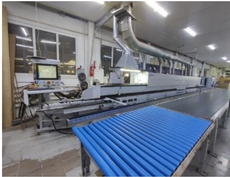
Рис. 2.5. LOORTEQ O-300 частина подачі та приймання деталей
