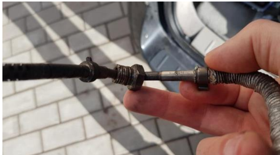
Рис. 4.10. Заміна датчика у DPF
