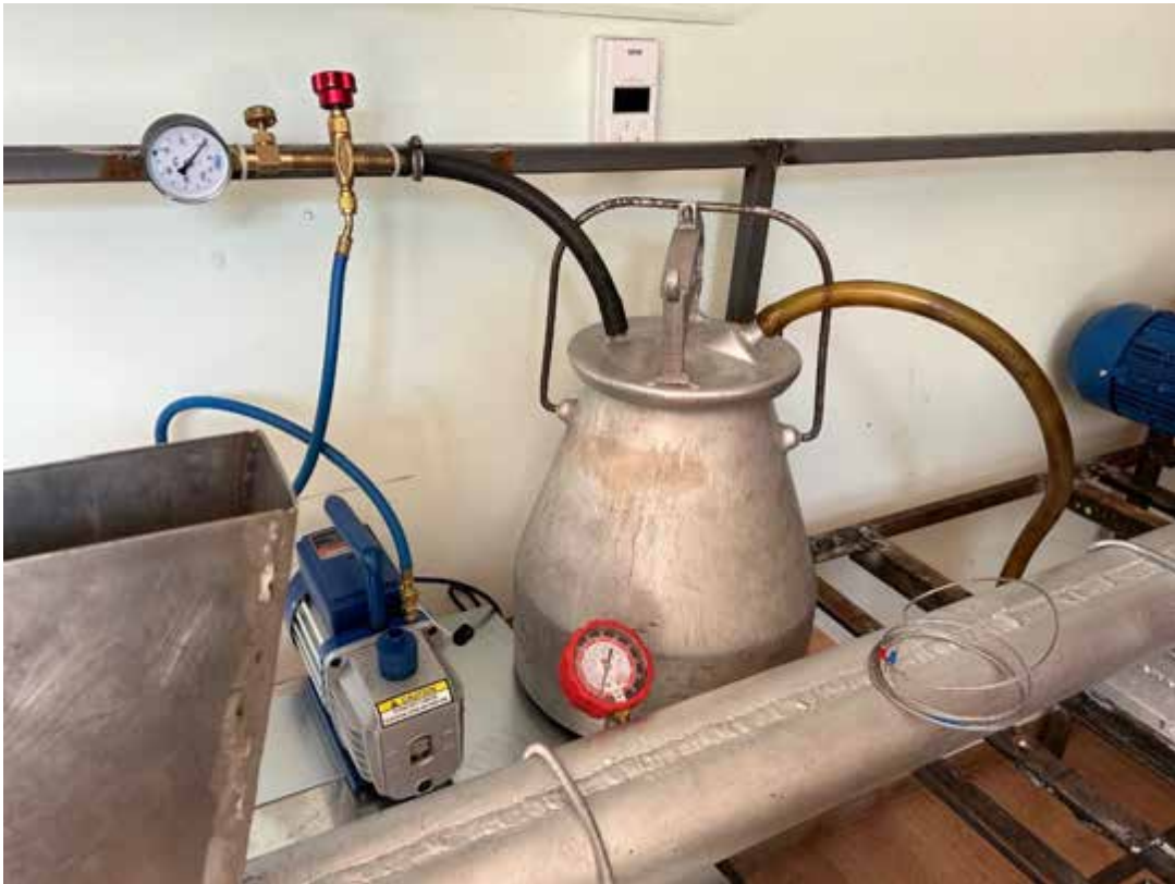
Рис.4.13. Монтаж манометра та в ущільнюючій порожнині корпуса гідролізера Тиск в зоні ущільнюючих конусів та тиск в реакційній високотемпературній порожнині робочої частини гідролізера вимірюється високотемпературними діафрагмовими манометрами моделі М230, 16 МРа. Монтаж манометрів показано на рис.4.14.
