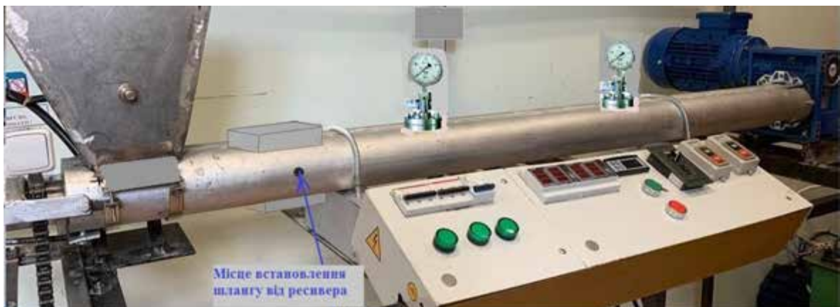
Рис.4.13. Монтаж манометра та в ущільнюючій порожнині корпуса гідролізера Тиск в зоні ущільнюючих конусів та тиск в реакційній високотемпературній порожнині робочої частини гідролізера вимірюється високотемпературними діафрагмовими манометрами моделі М230, 16 МРа. Монтаж манометрів показано на рис.4.14.
