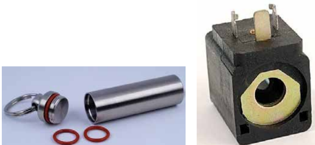
Рис. 2.2. Комплектація приладів для розміщення зразків кератиновмісної сировини про експериментальному оцінюванні впливу магнітного поля: а - капсула-контейнер; б – котушка електромагнітна (соленоїд)
