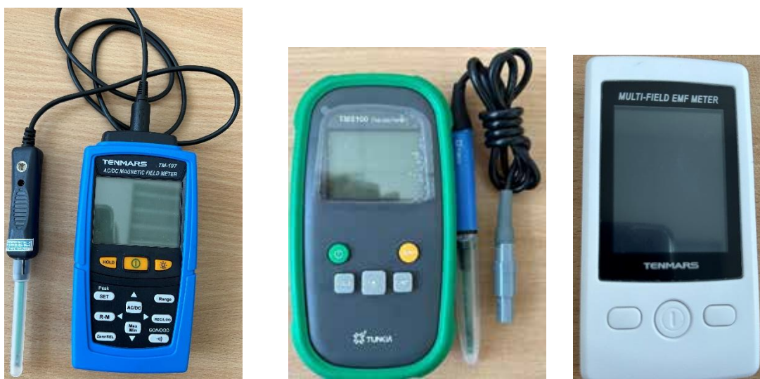
Рис. 4.7. Прилади для виміру індукції і частоти магнітного поля в ущільнюючій порожнині робочої частини гідролізера
