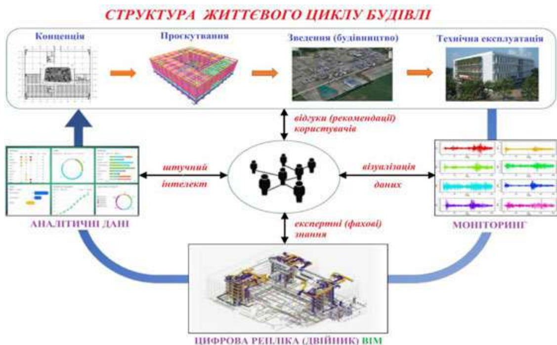
Рис. 1.3. Структурна схема життєвого циклу будівлі та/або споруди з використанням DTM [3]
