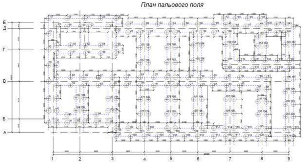
Рис. 5.2. План пального поля житлової будівлі
