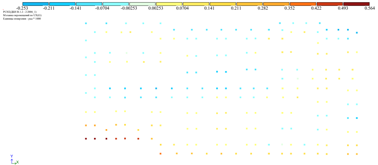
Рис. 5.4 Ізополя переміщень плити U_x , рад
