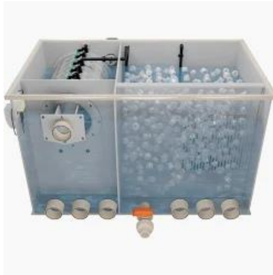
Рис. 2.1. Комбінований барабанний фільтр для УЗВ
