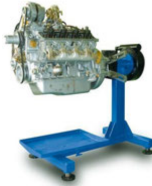
Малюнок 2.2 Зовнішній вигляд станда Р 500Е
