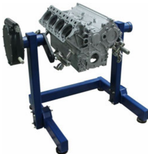
Малюнок 2.5 - Зовнішній вигляд стенда ОПР- 989
