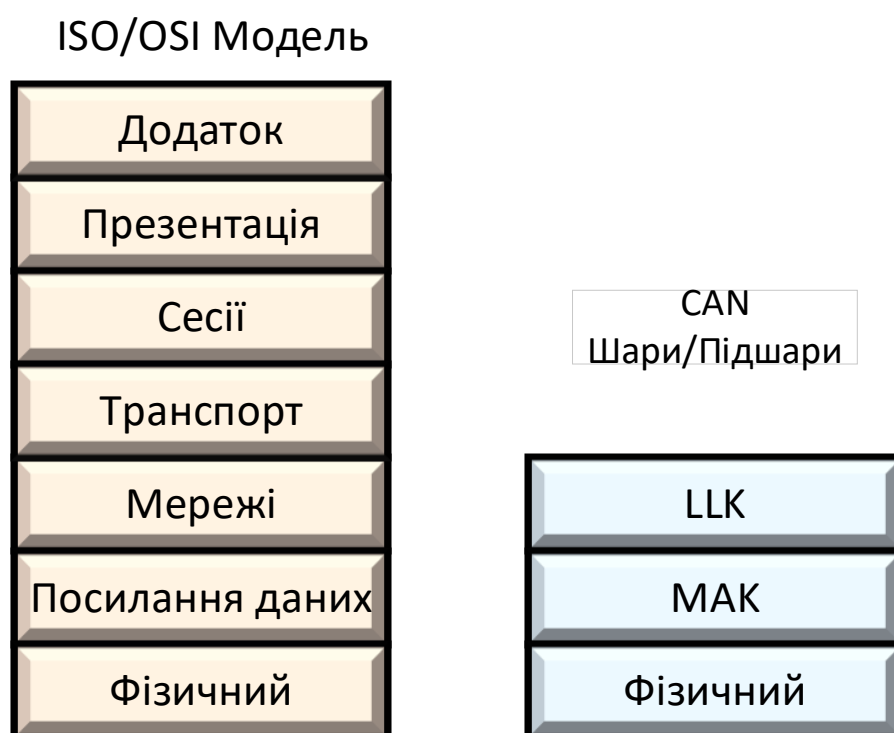
Рис. 4.4. Логічна структура протоколу CAN
