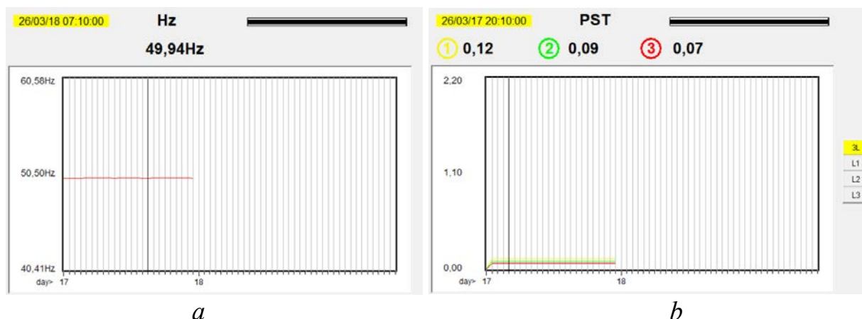
Рис. 2.8. Графіки частоти мережі (Hz) a та короткочасного показника дози флікера (Pst) b
