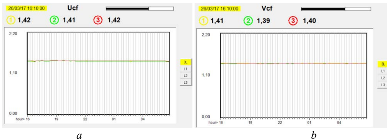
Рис. 2.6. Графіки амплітудного коефіцієнта лінійної напруги ( U_{cf} ) a та фазної напруги ( V_{cf} ) b
