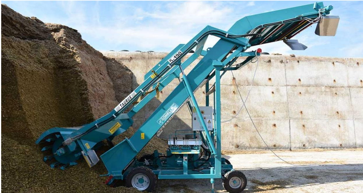
Рис.3.6. Самохідна фреза для нарізання та завантаження силосних мас Gonella Taurus 5-190.
