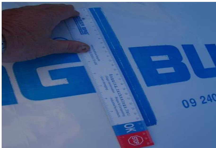
Рис.3.2. Перевірка щільності утрамбованої маси за допомогою лінійки по лінії розтягнення.
