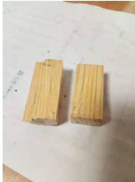
Рис. 3.8 Зображення одного з зруйнованих зразків
