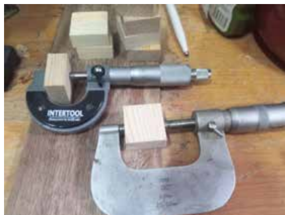
Рис. 3.2 Вимірювання розмірів зразків
