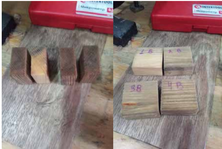
Рис. 3.3 Зразки після замочування
