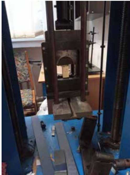
Рис. 3.6 Встановлення зразку у випробувальну машину
