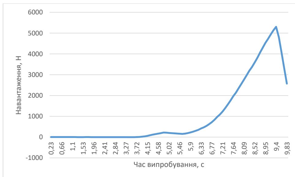
Рис. 3.7 Результат визначення межі міцності по одному із зразків
