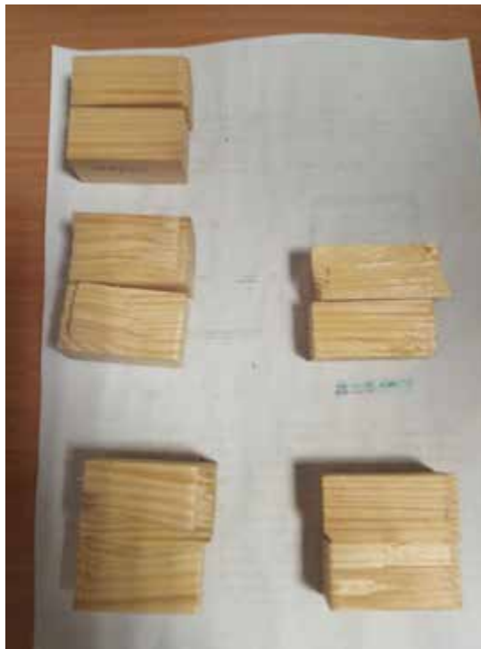
Рис.3.10 Зразки після дослідів на сколювання
