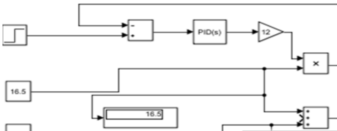
Рис. 2.8 Математична модель системи локального обігріву приміщення
