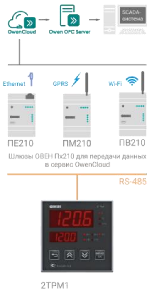
Рис. 3.10. Структурна схема дистанційного моніторингу температури
