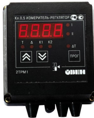
Рис. 5.2. Зовнішній вигляд двопозиційного регулятора AQtack 2TRM1
