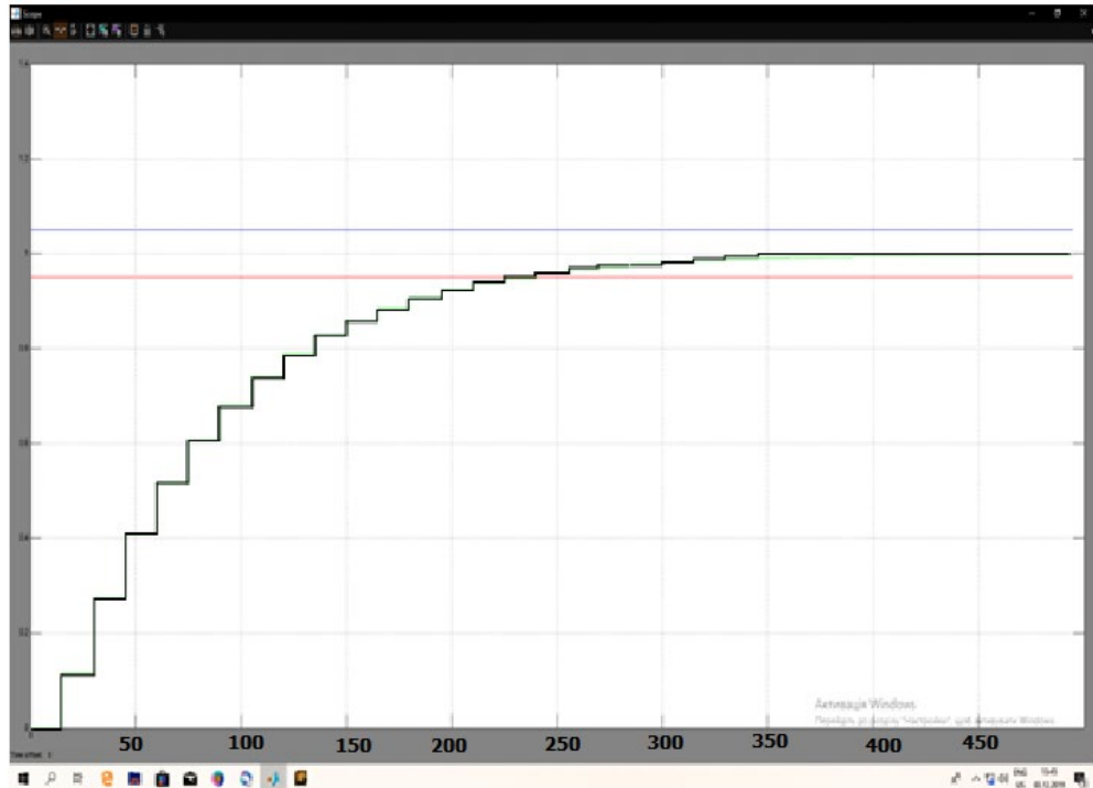
Рис. 4.3. Перехідний процес цифрової системи з ПІД-регулятором
