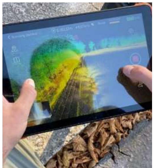
Рисунок 22. Формування хмари точок у режимі реального часу під час мобільного лазерного сканування.
