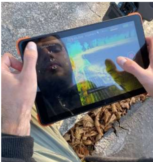
Рисунок 21. Контроль проходження опорних точок та моніторинг процесу сканування в програмному забезпеченні SLAM R100.
