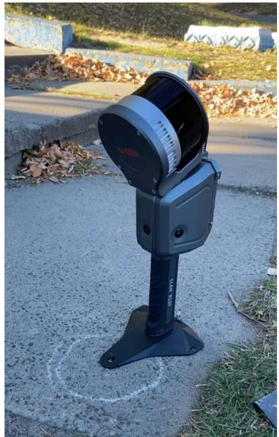
Рисунок 19. Встановлення сканера SLAM R100 на початковій опорній точці геодезичної основи.
