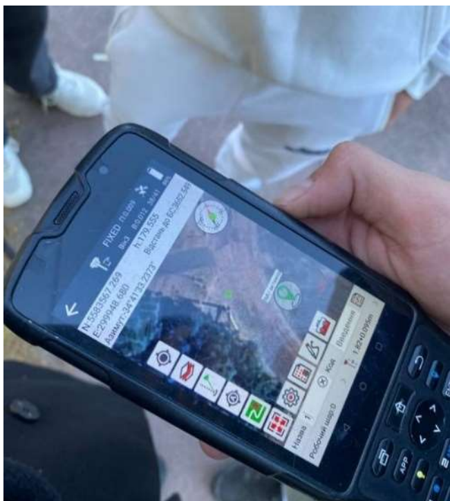
Рисунок 14. Визначення координат опорної точки за допомогою GNSS-приймача AlphaGeo GeoPuls
