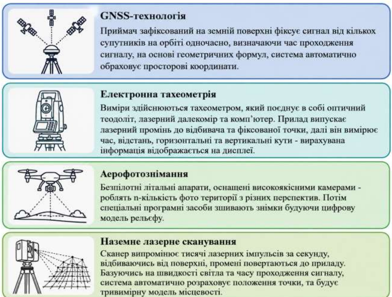
Рис. 1. Цифрові технології збору геопросторових даних та їхні характеристики.
