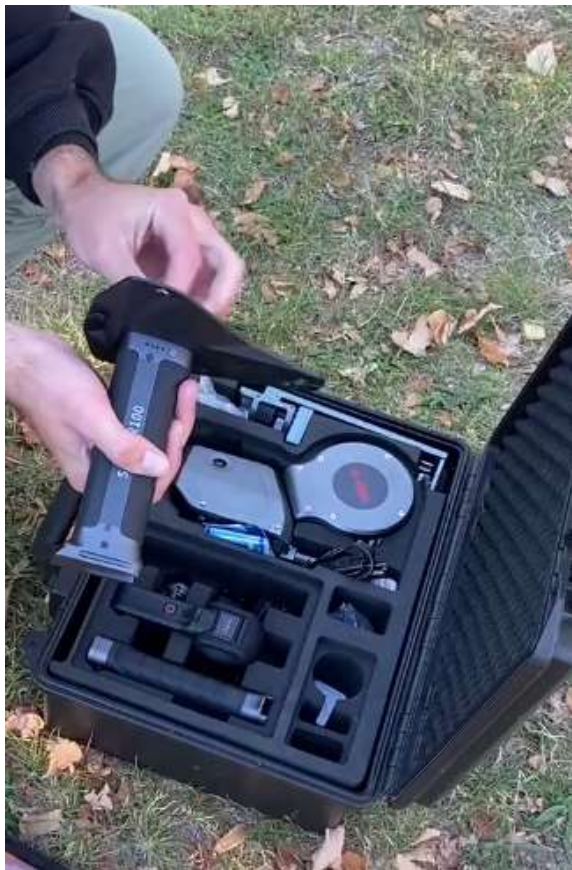
Рисунок 18. Підготовка та складання мобільного лазерного сканера SLAM R100 перед початком польових робіт.
