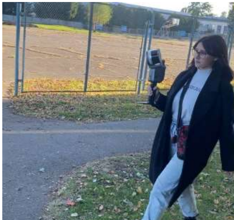
Рисунок 23. Виконання мобільного лазерного сканування території стадіону НУБіП України за допомогою сканера SLAM R100.
