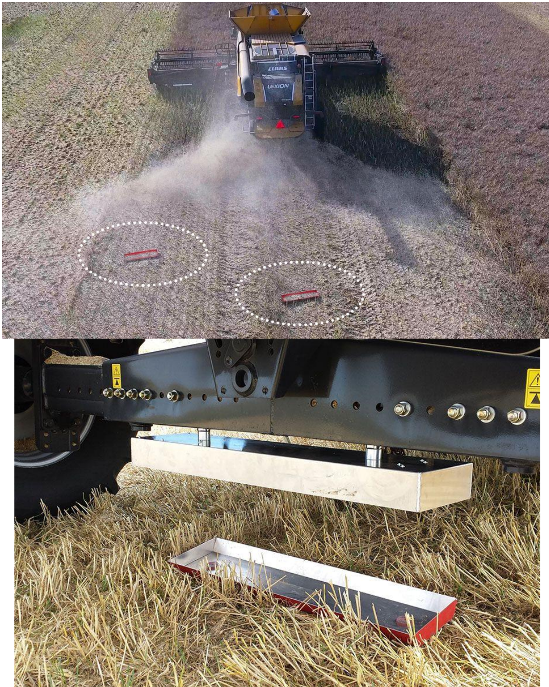
Рис. 2. Робочий момент під час взяття проби на втрати зерна – лаборант поміщає пробовідбірник між задніми колесами комбайна
