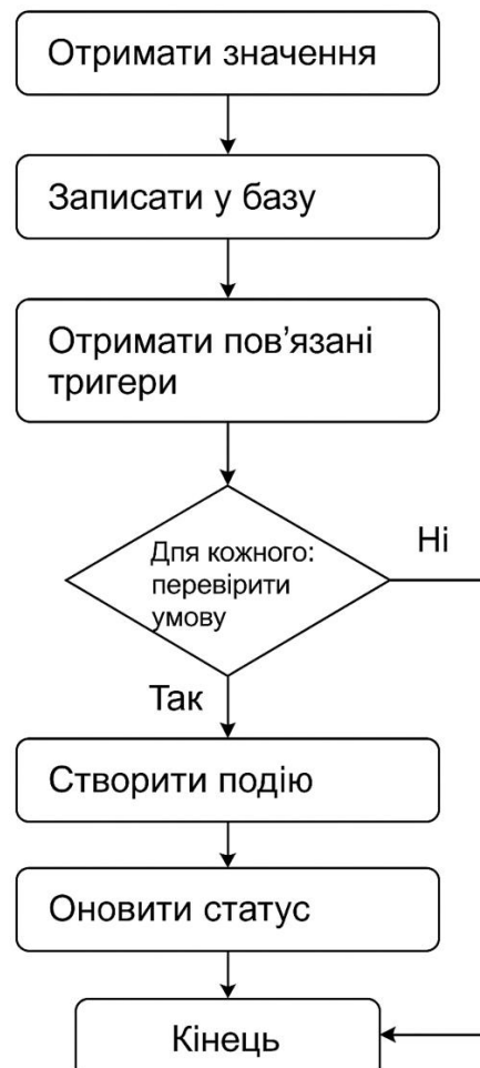
Рис. 3.1 Блок-схема алгоритму обробки нового значення
