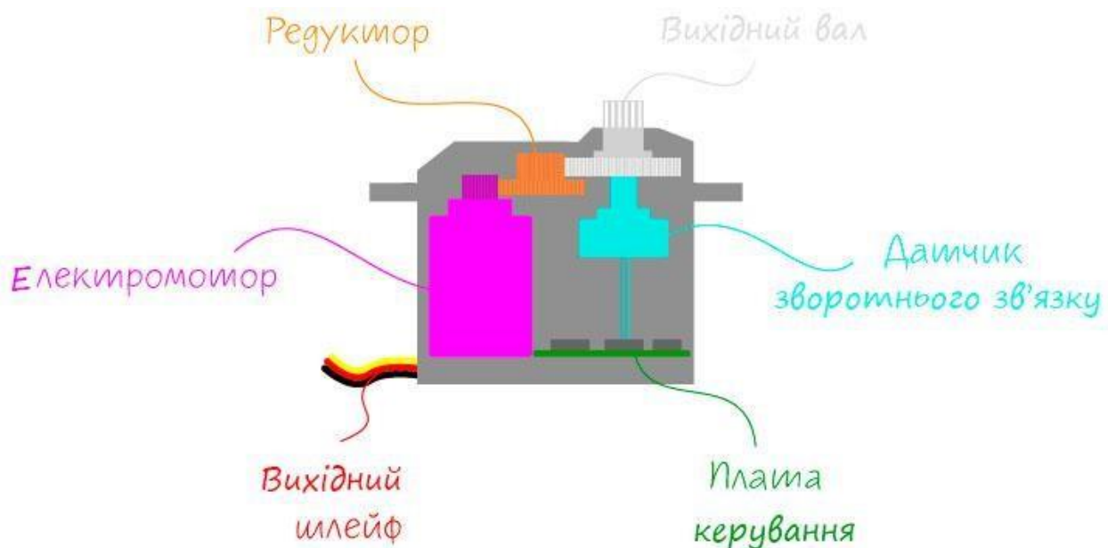
Рисунок 2.2 – Будова типового сервопривода.
