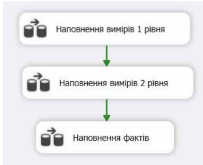
Рис. 3.3 – загальна схема ETL процесів АСОП
