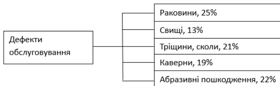
Рис. 1.3. Дефекти систем ОВТП
