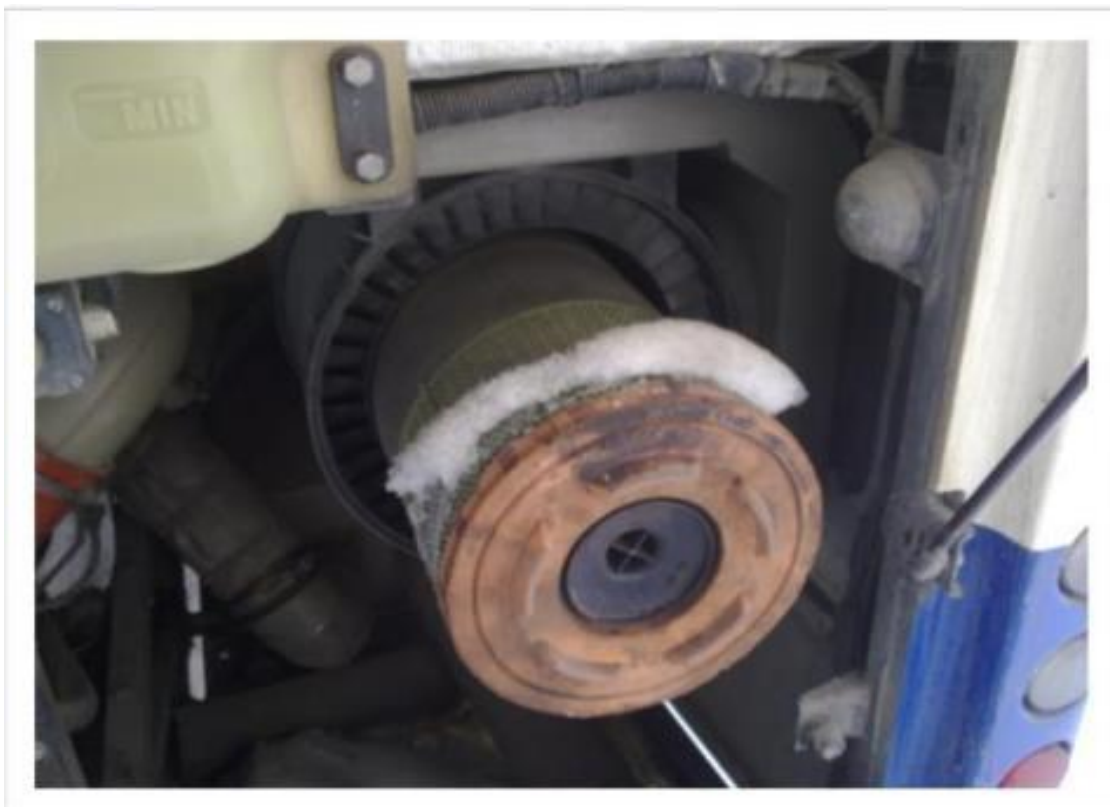
Рис.4.4. Намерзання льоду на пневмобалоні автобуса KAROSA C-934
