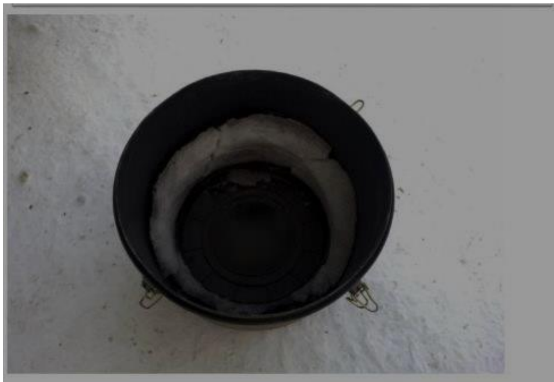
Рис.3.5. Утворення крижаної кірки в захисному кожуху пневмобалону автобуса KAROSA C-934
