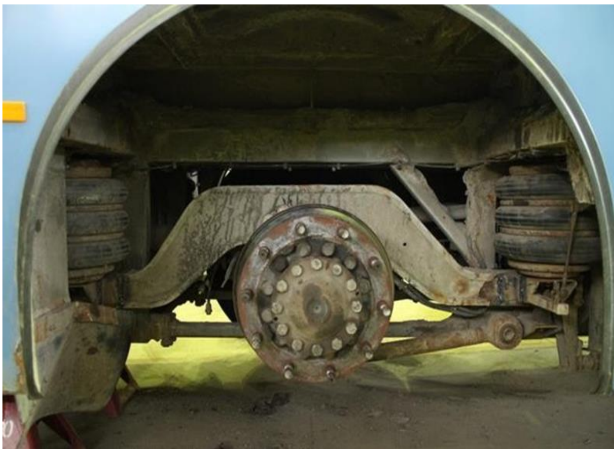
Рис. 5.3. Задня пневматична підвіска автобуса великого класу KAROSA-C934
