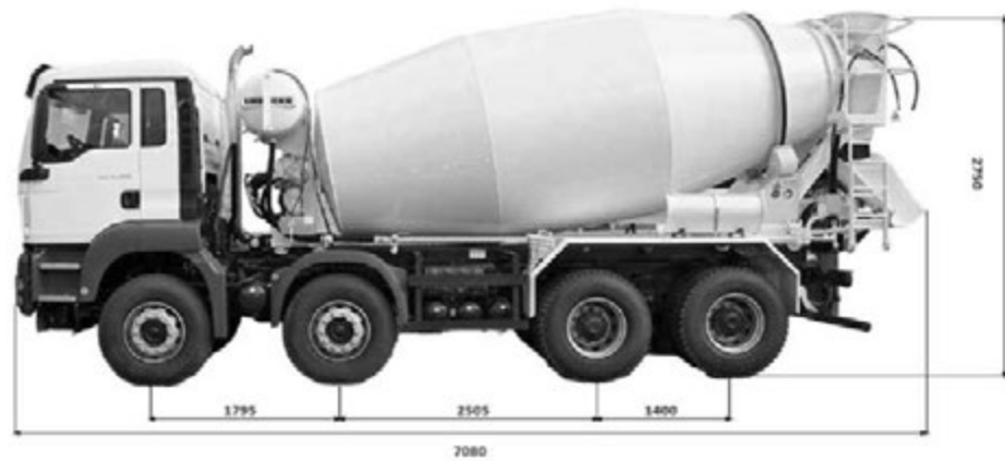
Рис. 6.11. Загальний вигляд автобетонозмішувача MAN TGS 41.4, технічні характеристики наведено у табл. 6.4.
