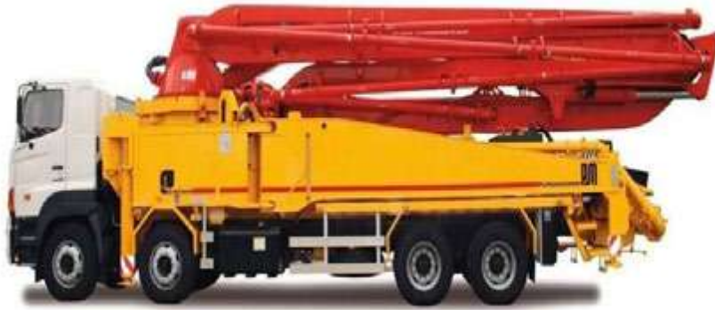
Рис. 6.10. Загальний вигляд бетононасоса на автомобільному ході АБН-60, технічні характеристики наведено в табл. 6.3.
