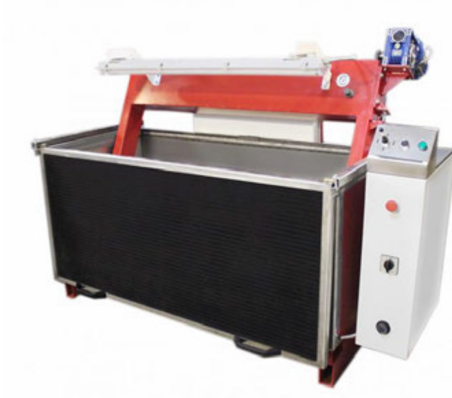
Рис.1.10. Установа для гідравлічних випробувань ГБЦ
