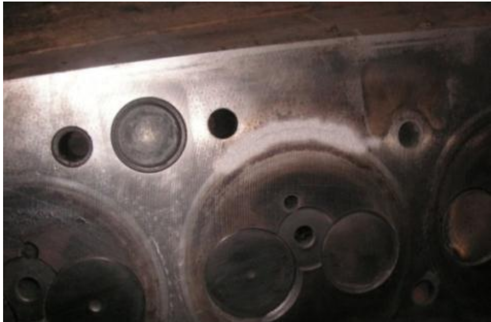
Рис. 1.17. Відновлення привалочної площини з глибокою корозією поверхні.
