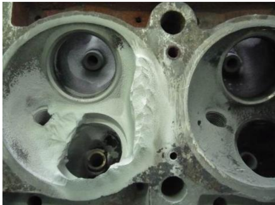
Рис. 1.18. Відновлення зруйнованих міжклапанних перемичок головок циліндрів.
