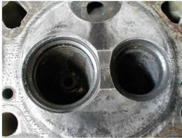
Рис. 1.17. Головка циліндрів до ремонту
