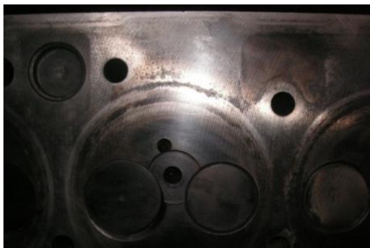
Рис. 1.3. Ерозія в районі каналів охолодження.
