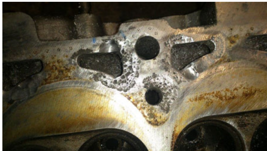
Рис. 1.21. Головка циліндрів до ремонту
