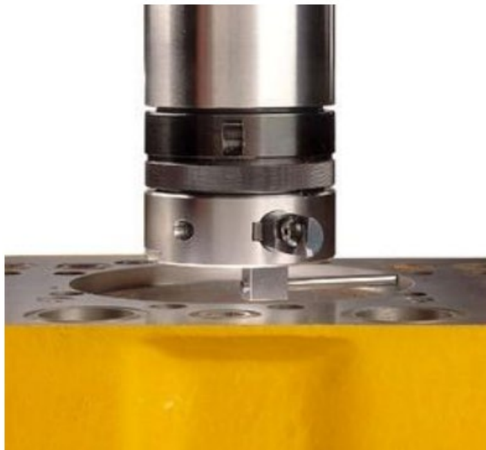
Рис. 5.8. Принцип забезпечення співвісності шпинделя обладнання з віссю оброблюваного отвору
