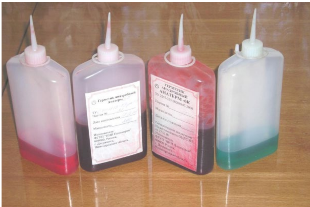
Рис. 5.19. Анаеробні герметики АН-6К, АН-6В та акриловий адгезив АН-105
