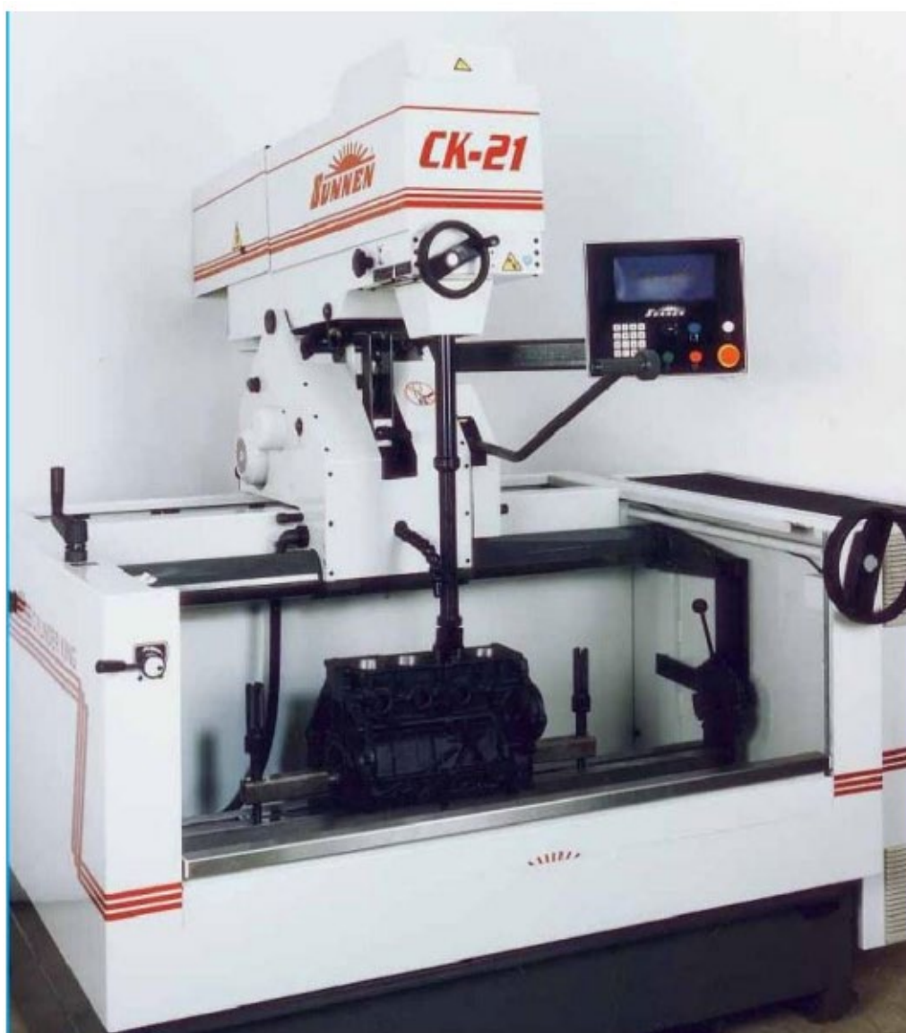
Рис. 5.6. Загальний вид установки ГКО відновлення внутрішніх поверхонь гільз циліндрів двигунів
