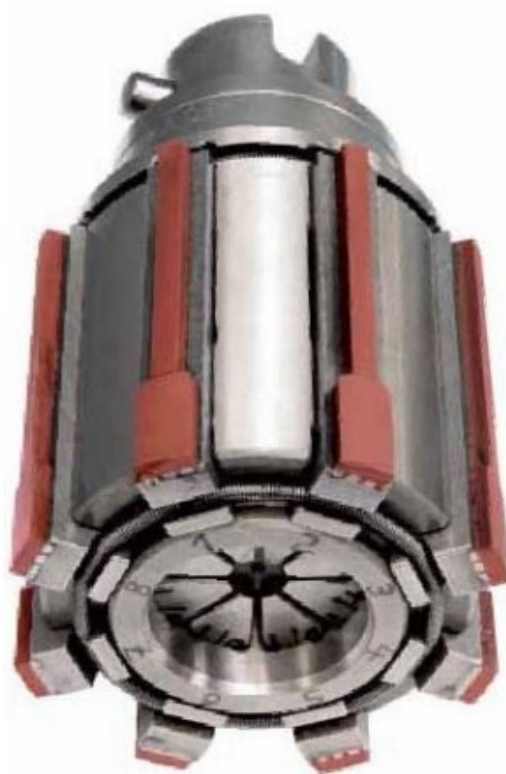
Рис. 5.7. Інструмент для нанесення композитних покриттів на основі заліза на внутрішні циліндричні поверхні
