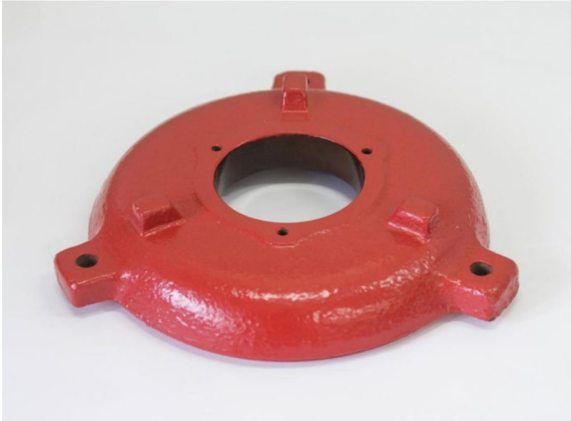
Рис. 5.22. Підшипниковий щит електродвигуна з посадковим місцем підшипника відновленим герметиком Ф-40
